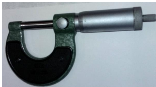
Slika 3.8.2. Uređaj za određivanje debljine listova
