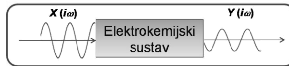
Slika 2.5.2.1. Shematski prikaz mjerenja impedancije
