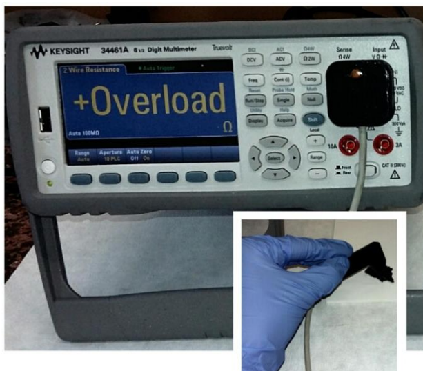
Slika 3.8.1. Uređaj i sonda za mjerenje električnog otpora
