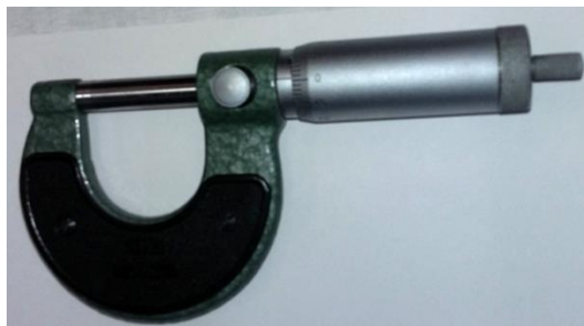
Slika 3.8.2. Uređaj za određivanje debljine listova
