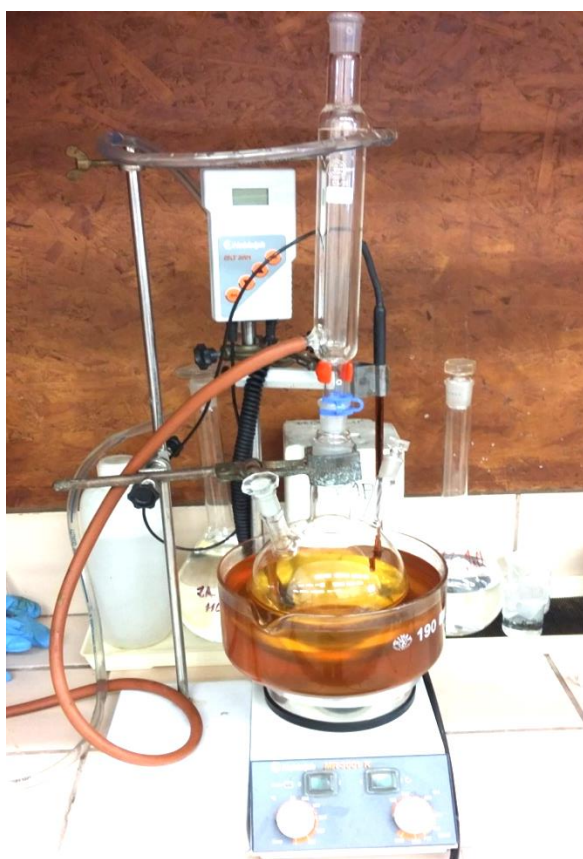
Slika 3.3.1.2. Aparatura za provedbu redukcije
