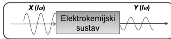
Slika 2.5.2.1. Shematski prikaz mjerenja impedancije
