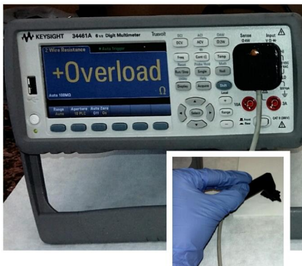
Slika 3.8.1. Uređaj i sonda za mjerenje električnog otpora
