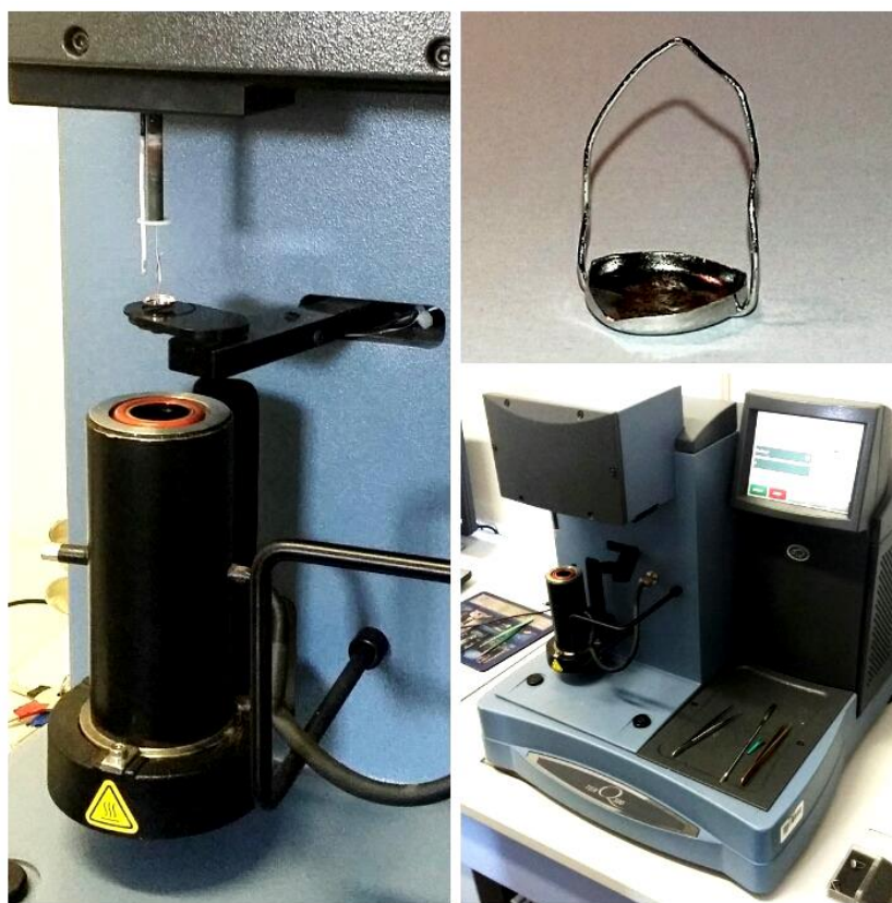
Slika 3.7.1. Instrument i uzorak za termogravimetrijsku analizu
