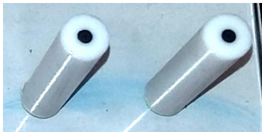
Slika 3.5.1.1. Elektrode od staklastog ugljika (GC)
