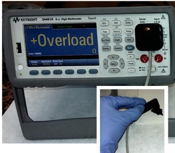
Slika 3.8.1. Uređaj i sonda za mjerenje električnog otpora
