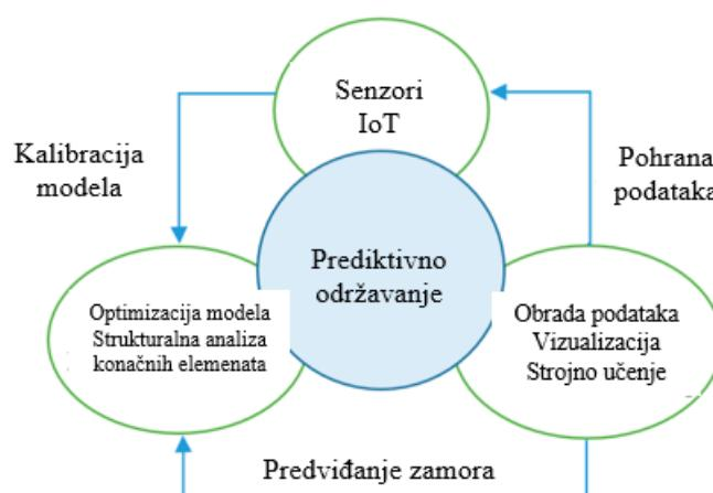
Slika 13. Shema sustava digitalnog blizanca za održavanje [16]
