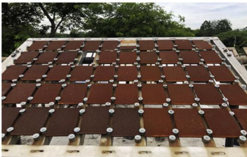
Slika 6. Stanica za ispitivanje atmosferske korozije u São Paulo-u, Brazil [12]
