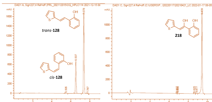
Slika 148. Retencijska vremena produkata trans - i cis - 128 i spoja 218 dobiveni HPLC analizom.
