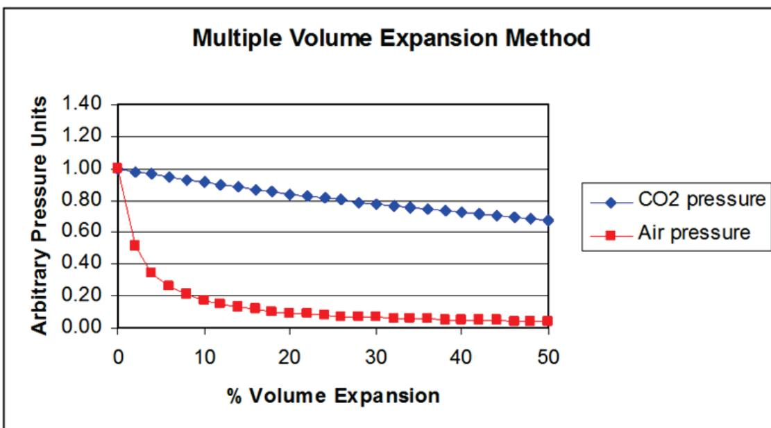
*Slika 12:* grafički prikaz ovisnosti o parcijalnom tlaku CO<sub>2</sub>, tlaku zraka u ovisnosti o volumnoj ekspanziji
