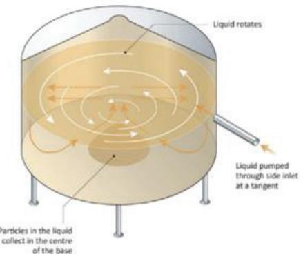
Slika 6; shematski prikaz posude za separaciju „whirlpool“
