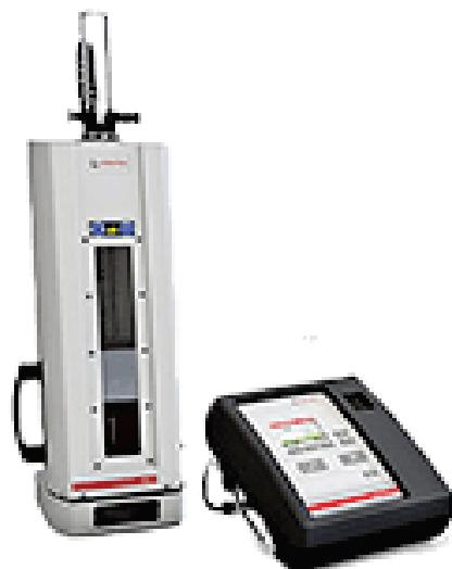
*Slika 11; prikaz mjerne opereme potrebne za mjerjenje DO i  $\text{DCO}_2$*
