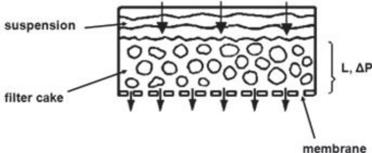
*Slika 4: shematski prikaz filterskog kolača tijekom lauteringa*
