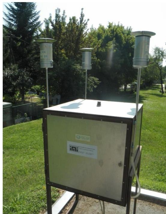
Slika 8. Uredaj vlastite izrade za sakupljanje frakcija lebdećih čestica  $\text{PM}_{10}$ ,  $\text{PM}_{2,5}$  i  $\text{PM}_1$
