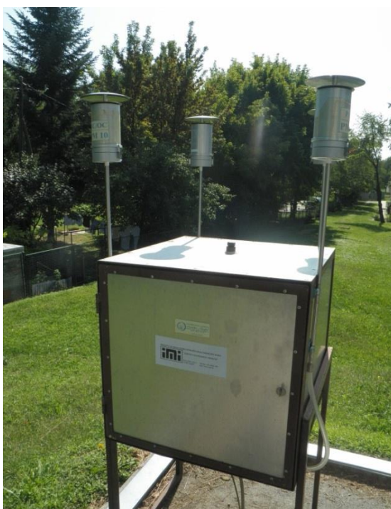
Slika 8. Uređaj vlastite izrade za sakupljanje frakcija lebdećih čestica PM_{10} , PM_{2,5} i PM_1
