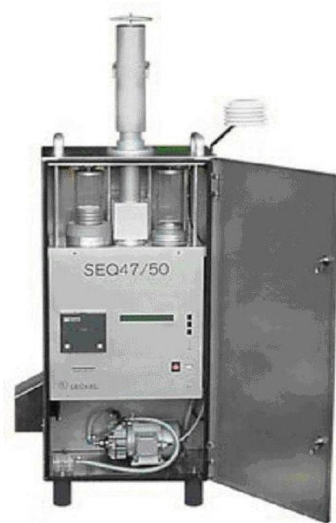
Slika 7. Sekvencijalni uredaj Sven Leckel Sequential Sampler SEQ47/50 za sakupljanje frakcija lebdećih čestica  $\text{PM}_{10}$ ,  $\text{PM}_{2,5}$  i  $\text{PM}_1$
