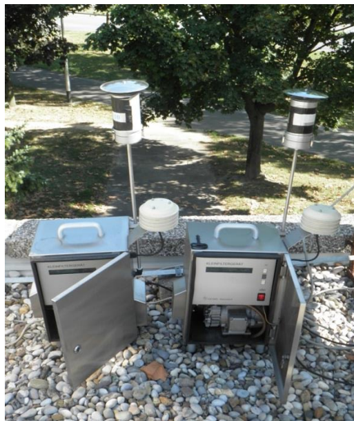
Slika 6. Referentni uređaj Sven Leckel LV3 za sakupljanje frakcija lebdećih čestica PM_{10} , PM_{2,5} i PM_1
