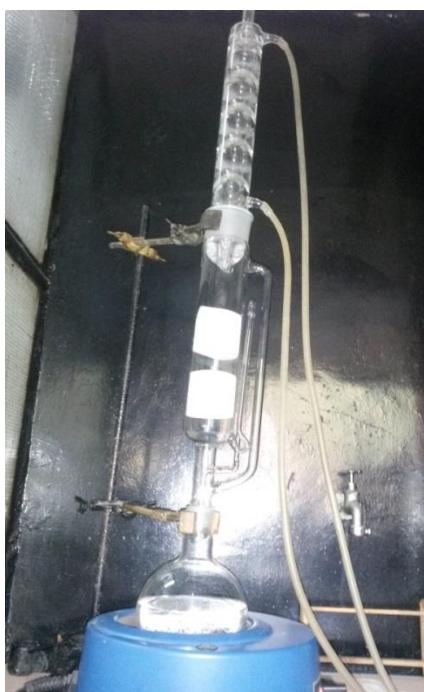
Slika 13. Soxhletova aparatura za ekstrakciju plinovitih PAU-a
