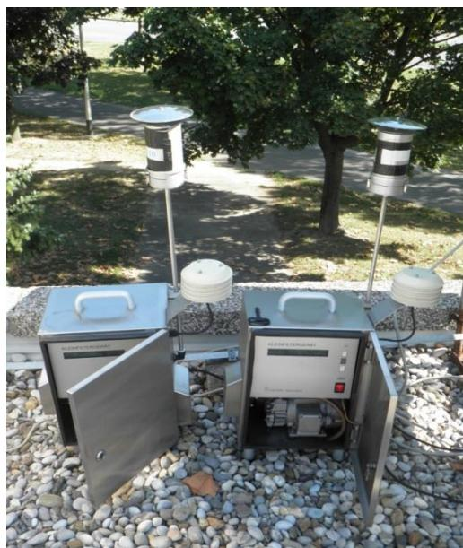
Slika 6. Referentni uređaj Sven Leckel LV3 za sakupljanje frakcija lebdećih čestica PM<sub>10</sub>, PM<sub>2,5</sub> i PM<sub>1</sub>
