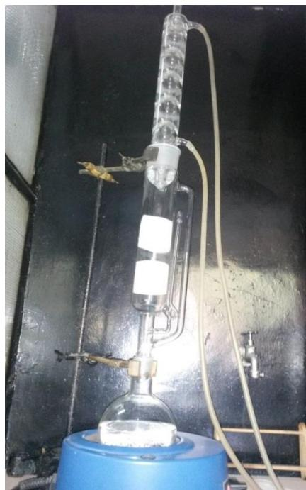
Slika 13. Soxhletova aparatura za ekstrakciju plinovitih PAU-a
