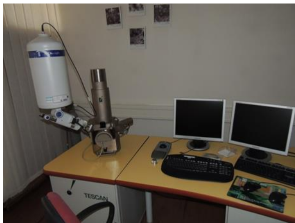
Slika 19. Pretražni elektronski mikroskop uz detektor energetske disperzivni spektrometar (SEM-EDS)
