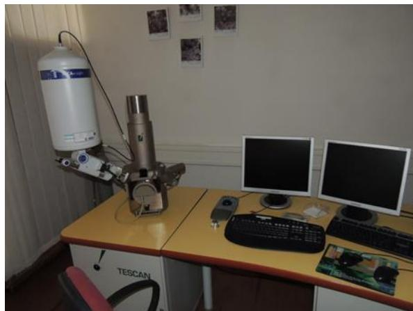
**Slika 19.** Pretražni elektronski mikroskop uz detektor energetsko disperzivni spektrometar (SEM-EDS)
