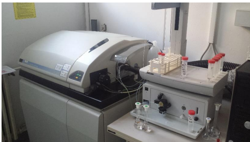
Slika 18. ICP-MS za određivanje sadržaja elemenata u tragovima
