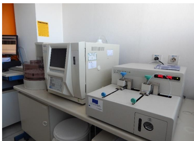
Slika 15. TOC analizator TOC-VCSH i jedinica za krute uzorke SSM-5000A
