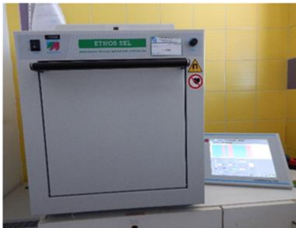
Slika 17. Uređaj za mikrovalnu digestiju
