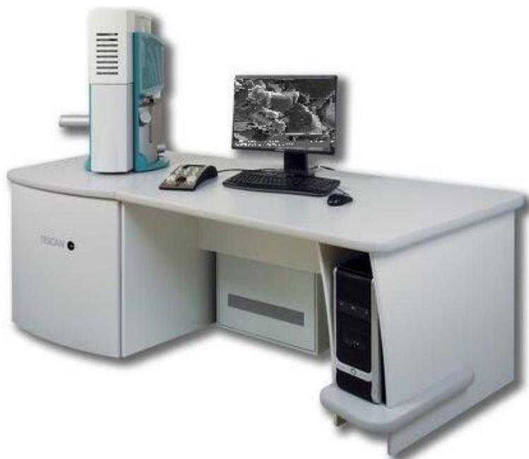
**Slika 42.** SEM – TESCAN VEGA 3 SBH Easy Probe
