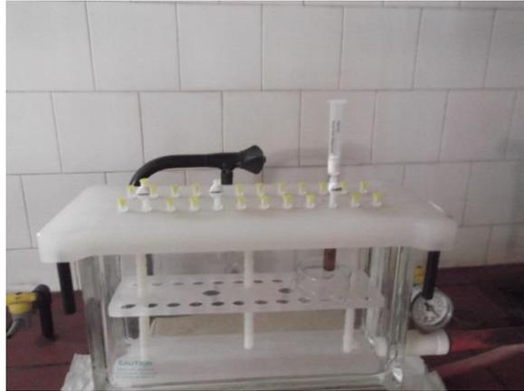
**Slika 39.** Višekolonski vakuumski SPE ekstraktor
