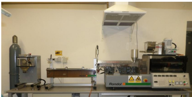
Slika 23. Rondol ekstruder 21 mm LAB TWIN
