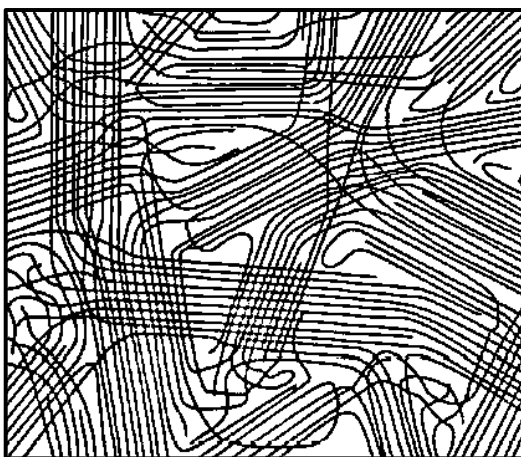
Slika 21. Nadmolekulska semikristalna struktura PE [1]
