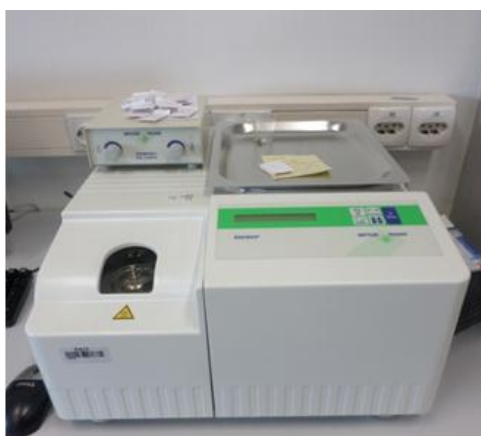
Slika 27. Razlikovni pretražni kalorimetar Mettler Toledo DSC 823e
