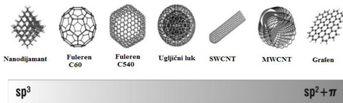
Slika 10. Mnoge kemijske i električne karakteristike spojeva ugljika su određene dominantnim hibridizacijskim stanjem ugljika [75].
