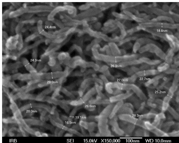
Slika 27. Prikaz uzorka 1 snimljenog SEM-om pri povećanju od 150000 puta.
