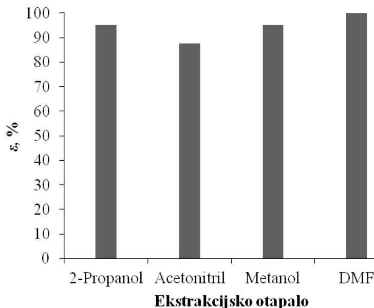
**Slika 4.69.** Usporedba iskorištenja ekstrakcije,  $\varepsilon$ , u procesu oksidacijske desulfurizacije realnog dizelskog goriva s različitim otapalima ( $S = 1$ ,  $T = 25^\circ\text{C}$ ,  $n = 1000 \text{ o min}^{-1}$ ,  $t = 25 \text{ min}$ )
