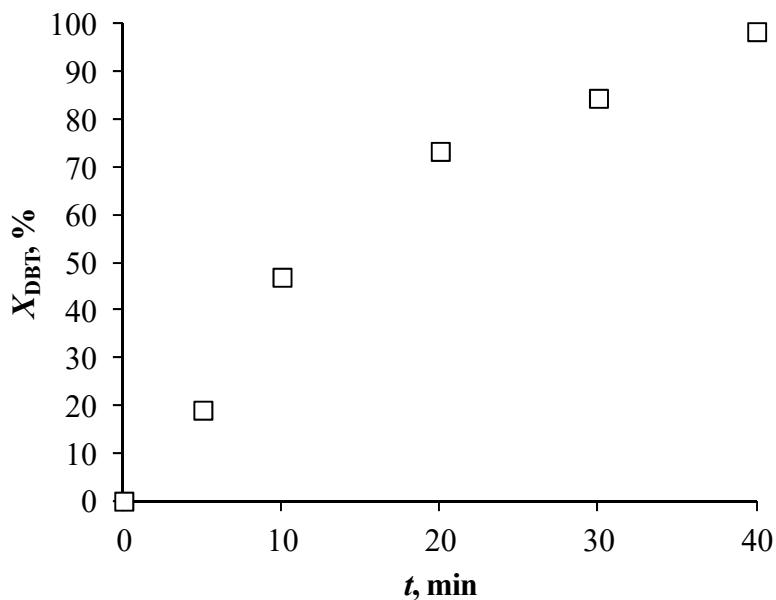
**Slika 4.32.** Ovisnost konverzije DBT-a,  $X_{\text{DBT}}$ , o vremenu reakcije,  $t$ , u sustavu vodikov peroksid/dodekafosfovolfraanova kiselina ( $T = 50^{\circ}\text{C}$ ,  $\text{O/K} = 32,55/1$ ,  $m_{\text{HPW}} = 0,1046 \text{ g}$ ,  $P = 70 \text{ W}$ , 80 %)
