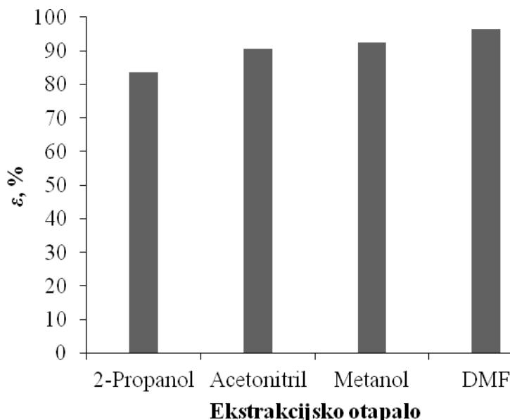
**Slika 4.68.** Usporedba iskorištenja ekstrakcije,  $\varepsilon$ , u procesu oksidacijske desulfurizacije modelnog dizelskog goriva s različitim otapalima ( $S = 1$ ,  $T = 25^\circ\text{C}$ ,  $n = 1000 \text{ o min}^{-1}$ ,  $t = 25 \text{ min}$ )
