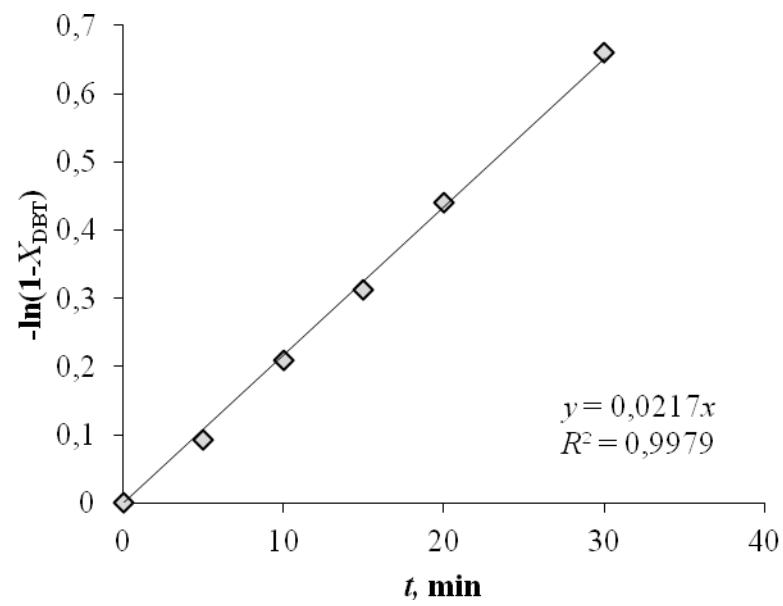
**Slika 4.82.** Ovisnost  $-\ln(1-X_{\text{DBT}})$  o vremenu,  $t$ , u sustavu vodikov peroksid/octena kiselina
