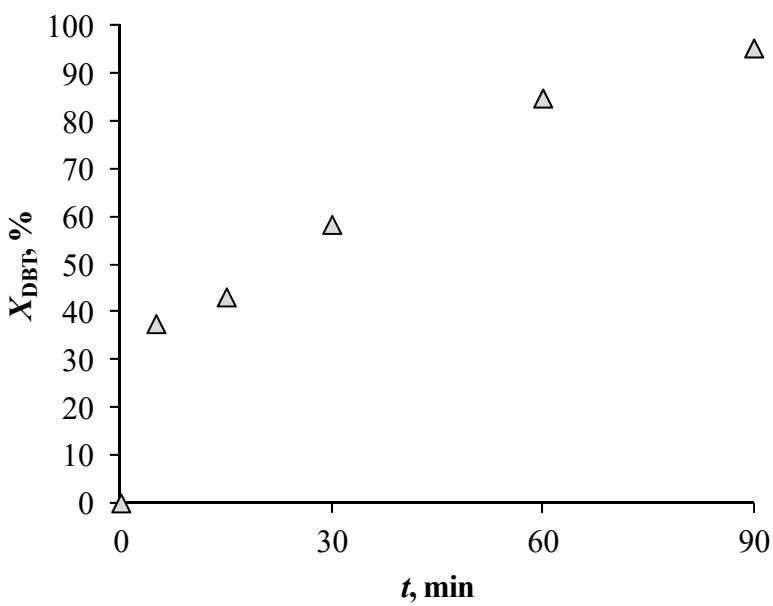
**Slika 4.18.** Ovisnost konverzije DBT-a,  $X_{\text{DBT}}$ , o vremenu reakcije,  $t$ , u sustavu vodikov peroksid/dodekafosfovolframova kiselina ( $T = 50 \text{ }^{\circ}\text{C}$ , O/K = 22,18/1,  $n = 2000 \text{ o min}^{-1}$ )
