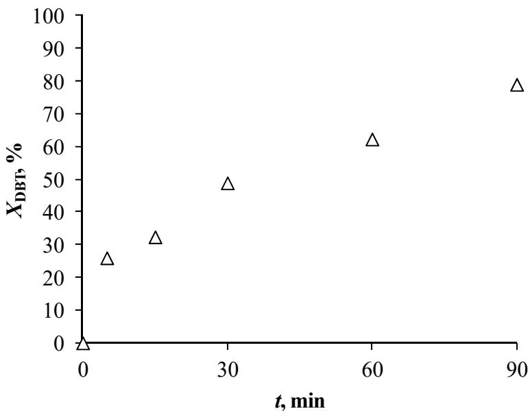
**Slika 4.17.** Ovisnost konverzije DBT-a,  $X_{\text{DBT}}$ , o vremenu reakcije,  $t$ , u sustavu vodikov peroksid/dodekafosfovolframova kiselina ( $T = 40 \text{ }^{\circ}\text{C}$ , O/K = 22,18/1,  $n = 2000 \text{ o min}^{-1}$ )
