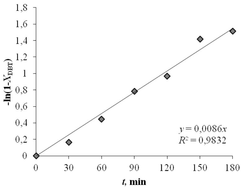
**Slika 4.79.** Ovisnost  $-\ln(1-X_{\text{DBT}})$  o vremenu,  $t$ , u sustavu vodikov peroksid/octena kiselina ( $T = 60 \text{ } ^\circ\text{C}$ ,  $\text{O/K} = 1/2$ ,  $n = 2000 \text{ o min}^{-1}$ )
