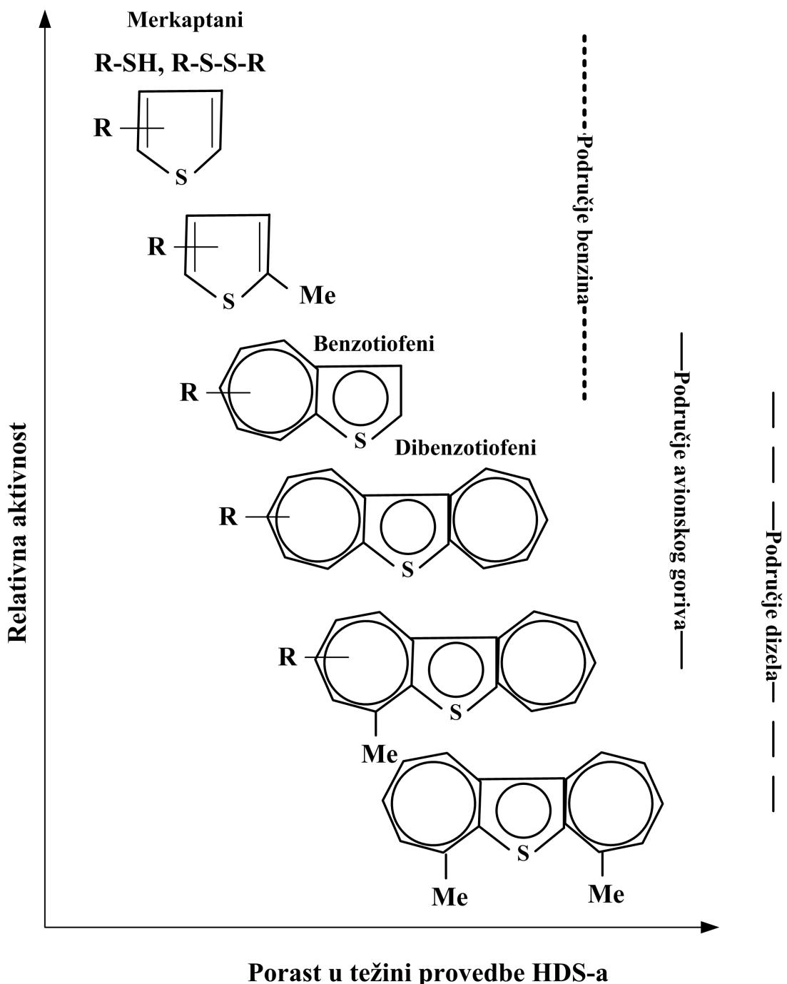
**Slika 2.19.** Prikaz reaktivnosti sumporovih spojeva prema obliku molekula i težini provedbe HDS-procesa [104]
