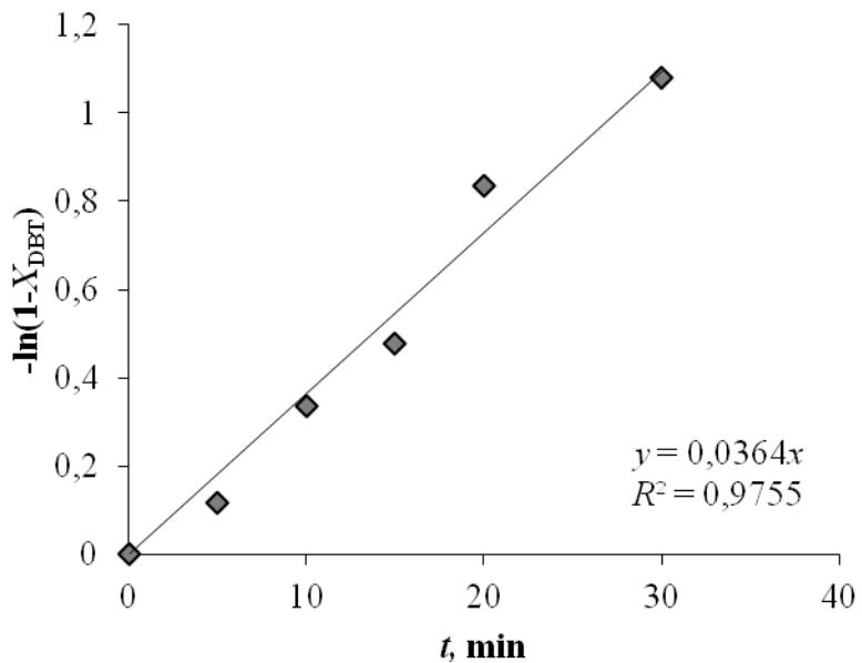
**Slika 4.83.** Ovisnost  $-\ln(1-X_{\text{DBT}})$  o vremenu,  $t$ , u sustavu vodikov peroksid/octena kiselina
