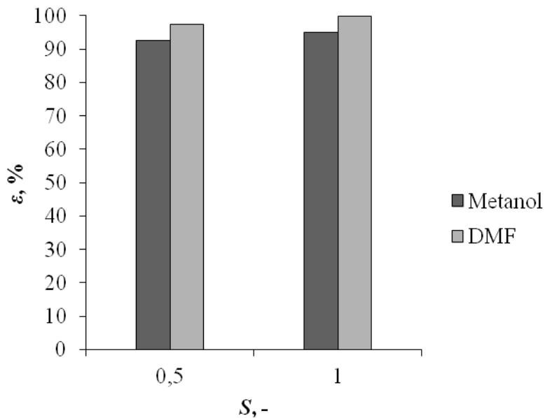
**Slika 4.71.** Utjecaj solvent-odnosa,  $S$ , na učinkovitost ekstrakcije,  $\varepsilon$ , u procesu oksidacijske desulfurizacije realnog dizelskog goriva za različita otapala ( $T = 25\text{ }^{\circ}\text{C}$ ,  $n = 1000\text{ o min}^{-1}$ ,  $t = 25\text{ min}$ )
