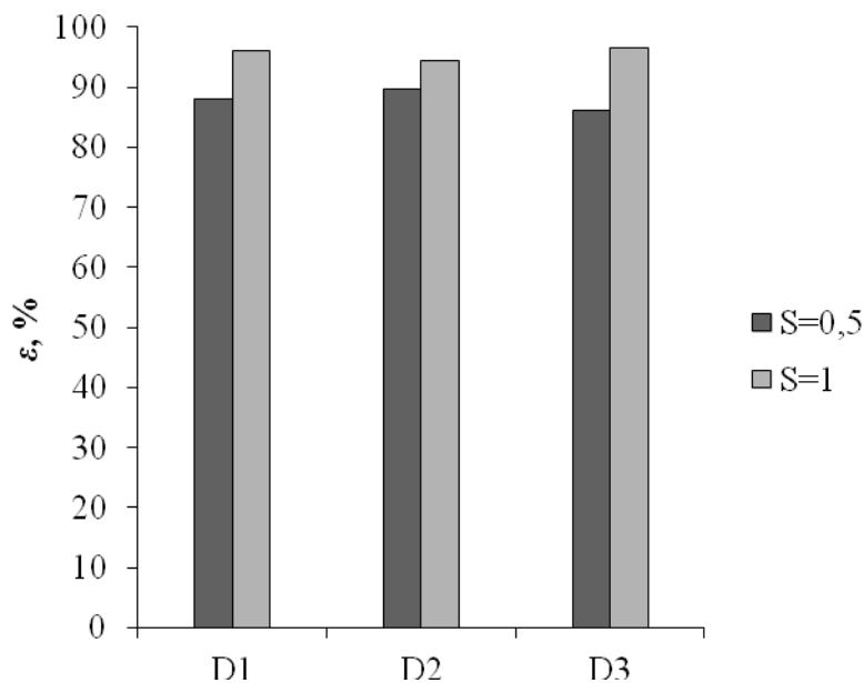
**Slika 4.72.** Utjecaj solvent odnosa,  $S$ , na učinkovitost ekstrakcije,  $\varepsilon$ , u procesu oksidacijske desulfurizacije za različita realna dizelska goriva uz DMF kao otapalo ( $T = 25\text{ }^{\circ}\text{C}$ ,  $n = 1000\text{ o min}^{-1}$ ,  $t = 25\text{ min}$ )
