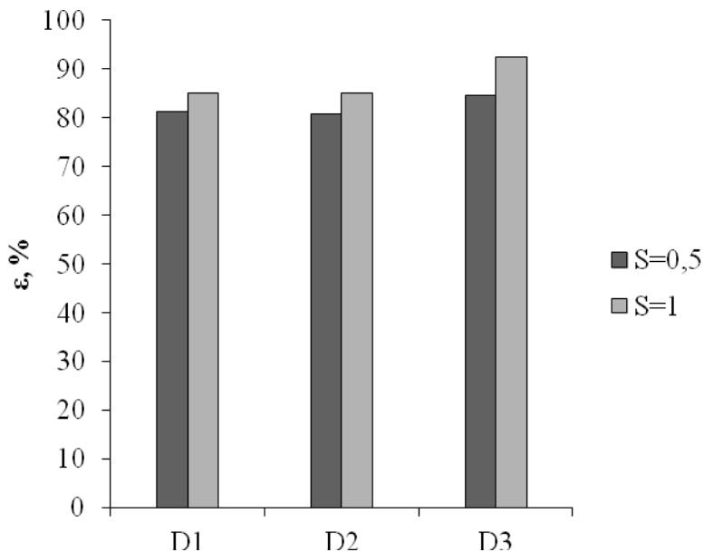
**Slika 4.73.** Utjecaj solvent odnosa,  $S$ , na učinkovitost ekstrakcije,  $\varepsilon$ , u procesu oksidacijske desulfurizacije za različita realna dizelska goriva uz metanol kao otapalo ( $T = 25^\circ\text{C}$ ,  $n = 1000 \text{ o min}^{-1}$ ,  $t = 25 \text{ min}$ )
