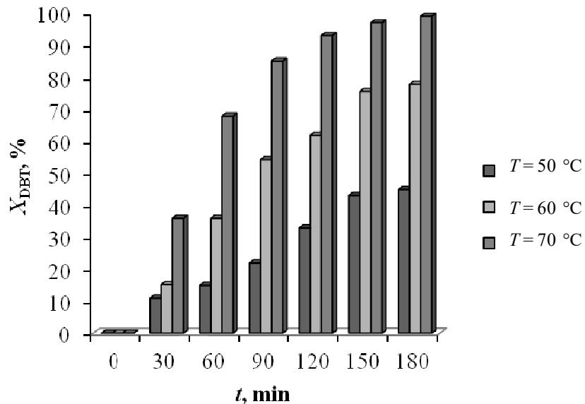
**Slika 4.11.** Utjecaj promjene temperature,  $T$ , u sustavu vodikov peroksid/octena kiselina na konverziju DBT-a,  $X_{\text{DBT}}$ , u ovisnosti o vremenu reakcije,  $t$  ( $\text{O/K} = 1/2$ ,  $n = 2000 \text{ o min}^{-1}$ )
