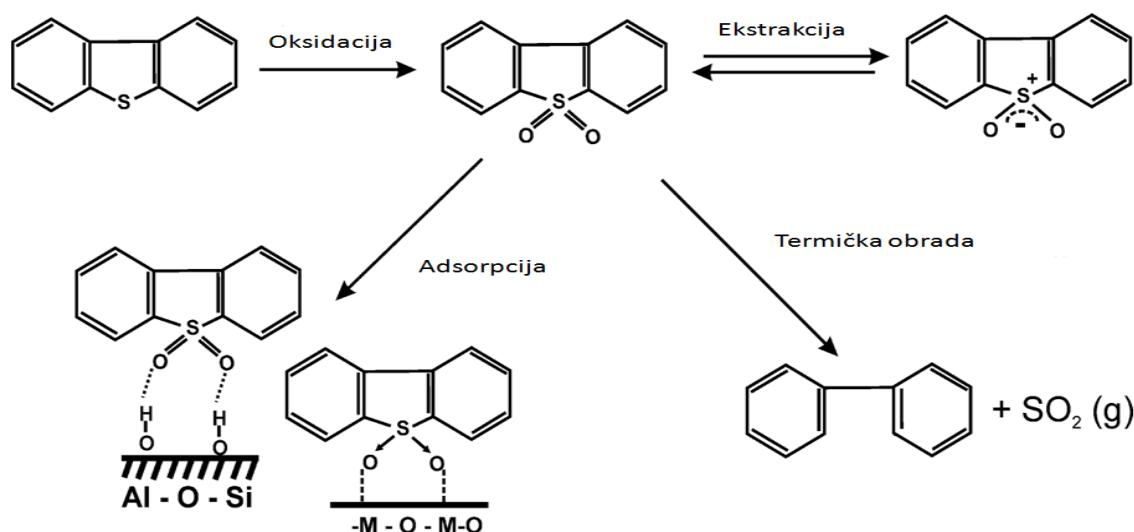
Slika 2.13. Reakcijska shema separacijskih procesa pri ODS [16]
