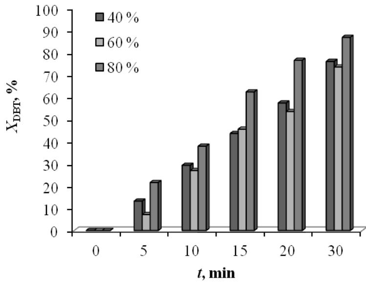
**Slika 4.43.** Utjecaj promjene amplitude ultrazvuka u sustavu vodikov peroksid/octena kiselina na konverziju DBT-a,  $X_{\text{DBT}}$ , u ovisnosti o vremenu reakcije,  $t$  ( $T = 70 \text{ }^{\circ}\text{C}$ , O/K = 1/2,  $P = 70 \text{ W}$ , 80 %)
