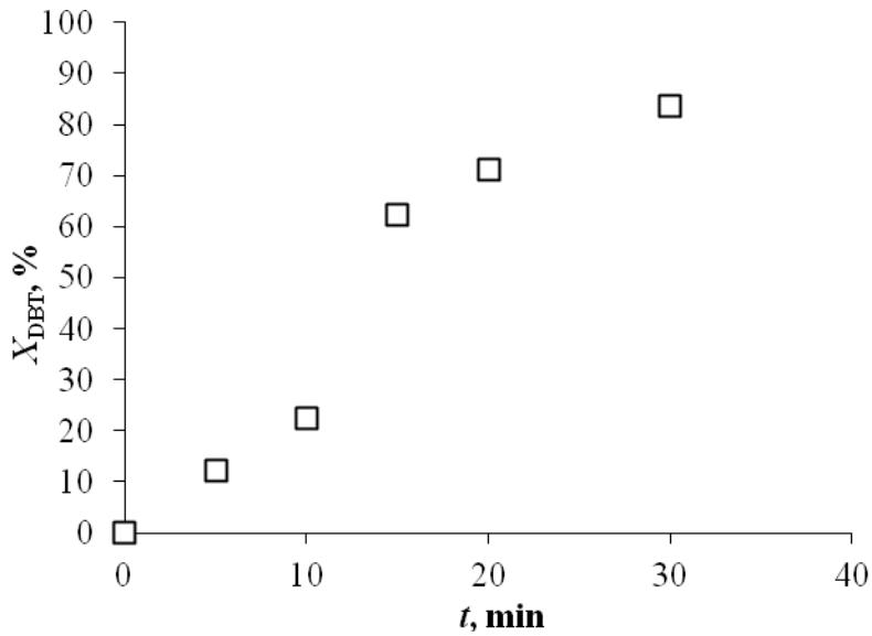
Slika 4.28. Ovisnost konverzije DBT-a,  $X_{\text{DBT}}$ , o vremenu reakcije,  $t$ , u sustavu vodikov peroksid/octena kiselina ( $T = 60^\circ\text{C}$ ,  $\text{O/K} = 1/1$ ,  $P = 70 \text{ W}$ , 80 %)
