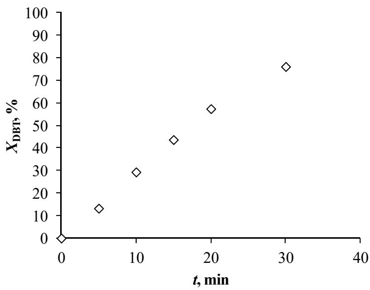
**Slika 4.40.** Ovisnost konverzije DBT-a,  $X_{\text{DBT}}$ , o vremenu reakcije,  $t$ , u sustavu vodikov peroksid/octena kiselina ( $T = 70^\circ\text{C}$ ,  $\text{O/K} = 1/2$ ,  $P = 70 \text{ W}$ , 40 %)
