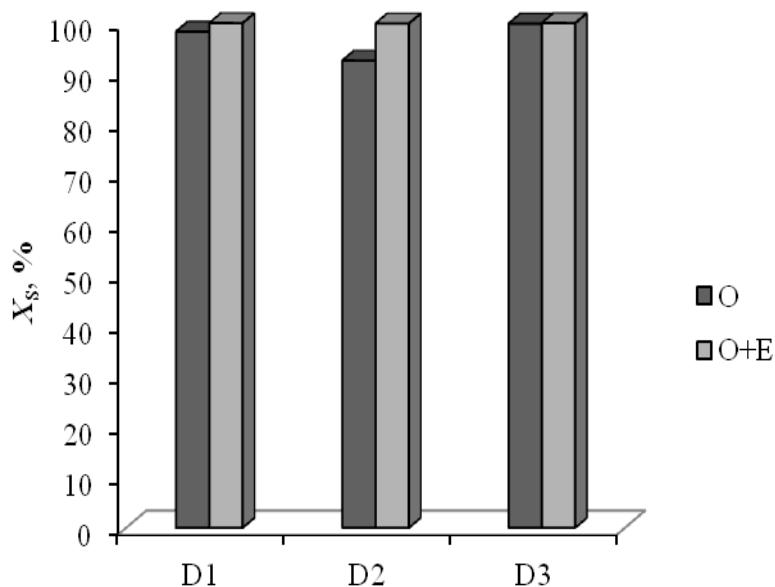
**Slika 4.67.** Ovisnost konverzije sumpora,  $X_S$ , o vrsti dizelskog goriva, D1, D2, D3, za reakciju oksidacije i integrirani proces oksidacije i ekstrakcije u sustavu vodikov peroksid/octena kiselina ( $T = 60^\circ\text{C}$ ,  $\text{O/K} = 1/2$ ,  $P = 70 \text{ W}$ , 80 %)
