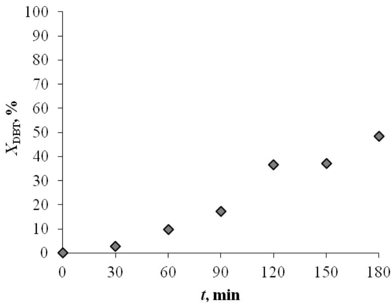
**Slika 4.51.** Ovisnost konverzije DBT-a,  $X_{\text{DBT}}$ , o vremenu reakcije,  $t$ , u sustavu vodikov peroksid/octena kiselina ( $T = 50 \text{ }^{\circ}\text{C}$ ,  $\text{O}/\text{K} = 1/2$ ,  $n = 1500 \text{ o min}^{-1}$ )
