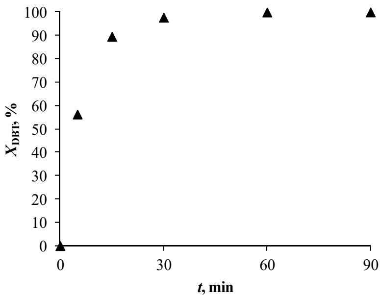
**Slika 4.20.** Ovisnost konverzije DBT-a,  $X_{DBT}$ , o vremenu reakcije,  $t$ , u sustavu vodikov peroksid/dodekafosfovolframova kiselina ( $T = 70\text{ }^{\circ}\text{C}$ ,  $\text{O/K} = 22,18/1$ ,  $n = 2000\text{ o min}^{-1}$ )
