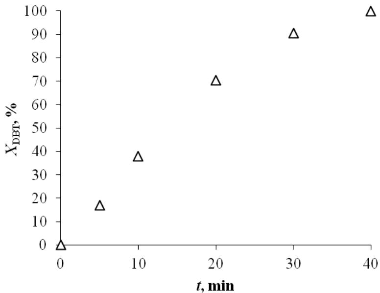
Slika 4.22. Ovisnost konverzije DBT-a,  $X_{\text{DBT}}$ , o vremenu reakcije,  $t$ , u sustavu vodikov peroksid/dodekafosfovolframova kiselina ( $T = 40 \text{ }^{\circ}\text{C}, \text{O/K} = 22,18/1, P = 70 \text{ W}, 80 \%$ )
