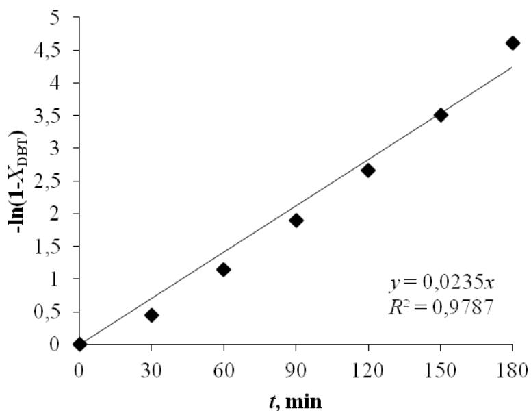
**Slika 4.80.** Ovisnost  $-\ln(1-X_{\text{DBT}})$  o vremenu,  $t$ , u sustavu vodikov peroksid/octena kiselina ( $T = 70 \text{ } ^\circ\text{C}$ ,  $\text{O/K} = 1/2$ ,  $n = 2000 \text{ o min}^{-1}$ )
