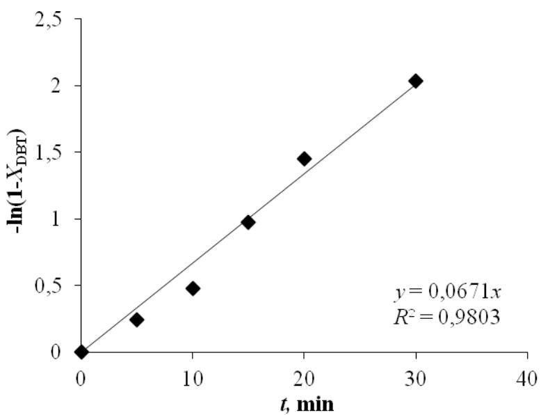
**Slika 4.84.** Ovisnost  $-\ln(1-X_{\text{DBT}})$  o vremenu,  $t$ , u sustavu vodikov peroksid/octena kiselina
