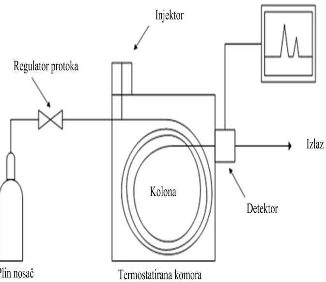
**Slika 3.4.** Fotografija plinskog kromatografa GC 2014, Shimadzu i shematski prikaz unutrašnjosti kromatografa [111]
