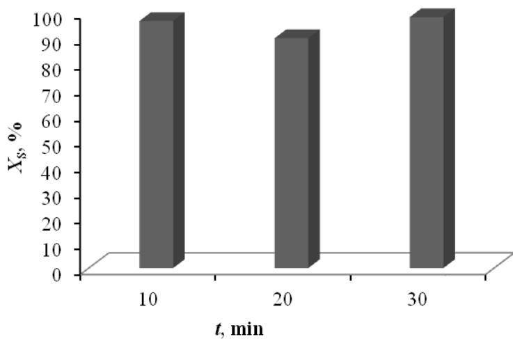
**Slika 4.61.** Ovisnost konverzije DBT-a,  $X_{\text{DBT}}$ , o vremenu reakcije,  $t$ , za realno dizelsko gorivo D3 sustavu vodikov peroksid/octena kiselina( $T = 60 \text{ }^{\circ}\text{C}$ , O/K = 1/2,  $P = 70 \text{ W}$ , 80 %)
