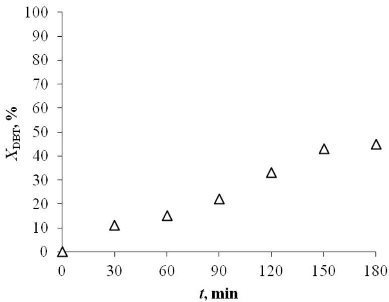
**Slika 4.8.** Ovisnost konverzije DBT-a,  $X_{\text{DBT}}$ , o vremenu reakcije,  $t$ , u sustavu vodikov peroksid/octena kiselina ( $T=50\text{ }^{\circ}\text{C}$ , O/K = 1/2,  $n = 2000\text{ o min}^{-1}$ )
