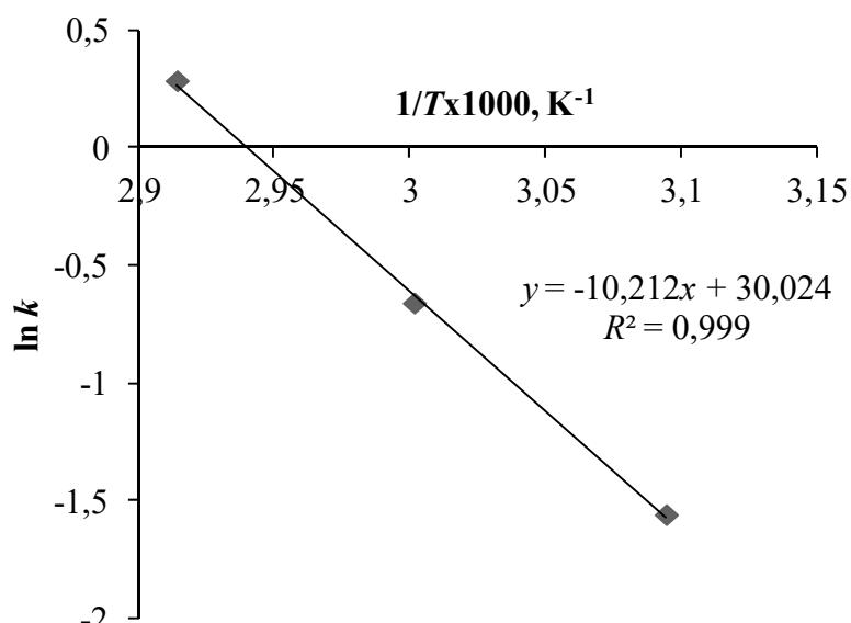
**Slika 4.93.** Grafički test Arrheniusova izraza, određivanje  $A$  i  $E_a$  u sustavu vodikov peroksid/octena kiselina ( $O/K = 1/2$ ,  $n = 2000 \text{ o min}^{-1}$ )
