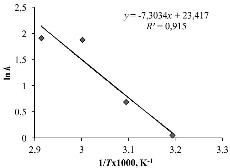
Slika 4.95. Grafički test Arrheniusova izraza, određivanje  $A$  i  $E_a$  u sustavu vodikov peroksid/dodekafosfovolframova kiselina (O/K = 22,18/1,  $n = 2000$  o min $^{-1}$ )
