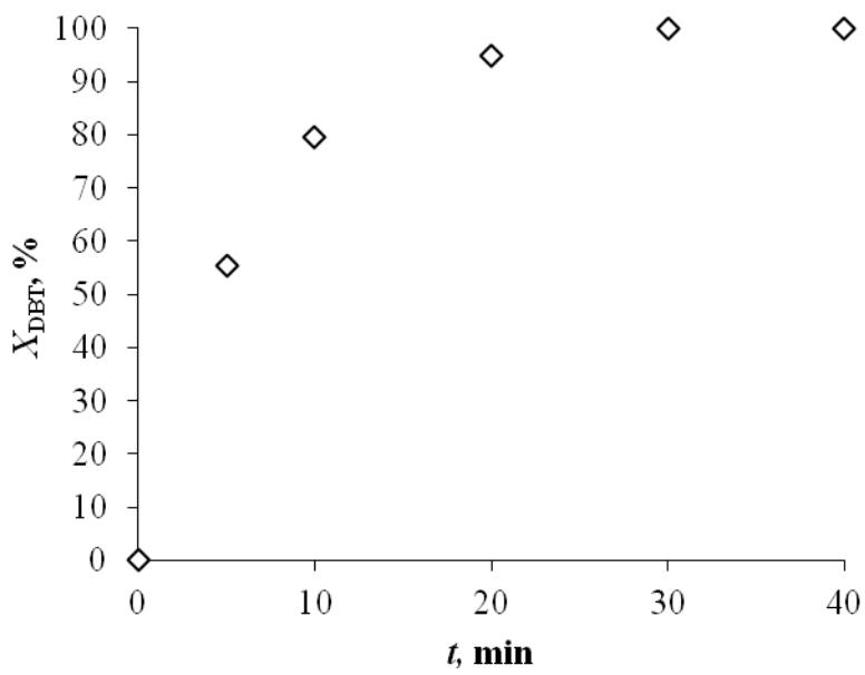
**Slika 4.44.** Ovisnost konverzije DBT-a,  $X_{\text{DBT}}$ , o vremenu reakcije,  $t$ , u sustavu vodikov peroksid/dodekafosfovolframova kiselina ( $T = 70 \text{ }^{\circ}\text{C}$ , O/K = 22,18/1,  $P = 70 \text{ W}$ , 50 %)
