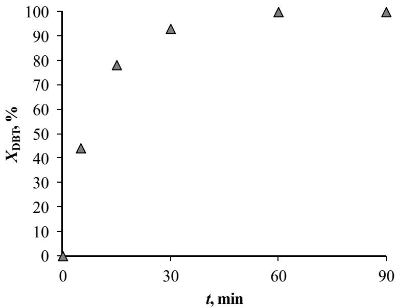
**Slika 4.19.** Ovisnost konverzije DBT-a,  $X_{DBT}$ , o vremenu reakcije,  $t$ , u sustavu vodikov peroksid/dodekafosfovolframova kiselina ( $T = 60\text{ }^{\circ}\text{C}$ ,  $\text{O/K} = 22,18/1$ ,  $n = 2000\text{ o min}^{-1}$ )
