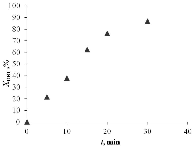
Slika 4.15. Ovisnost konverzije DBT-a,  $X_{\text{DBT}}$ , o vremenu reakcije,  $t$ , u sustavu vodikov peroksid/octena kiselina ( $T = 70 \text{ }^{\circ}\text{C}$ , O/K = 1/2,  $P = 70 \text{ W}$ , 80 %)
