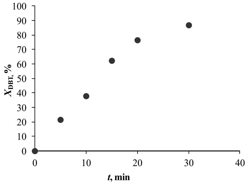
Slika 4.65. Ovisnost konverzije DBT-a,  $X_{\text{DBT}}$ , o vremenu reakcije,  $t$ , u sustavu vodikov peroksid/octena kiselina ( $T = 70^{\circ}\text{C}$ , O/K = 1/2,  $m_{\text{DBT}} = 0,6310$  g,  $P = 70$  W, 80 %)
