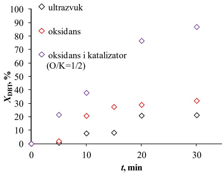
**Slika 4.39.** Utjecaj djelovanja ultrazvuka  $\diamond$ , uz dodatka oksidansa,  $\diamond$ , u sustavu vodikov peroksid/octena kiselina,  $\diamond$ , na konverziju DBT-a,  $X_{\text{DBT}}$ , u ovisnosti o vremenu reakcije,  $t$  ( $T = 70^\circ\text{C}$ ,  $P = 70 \text{ W}$ , 80 %)
