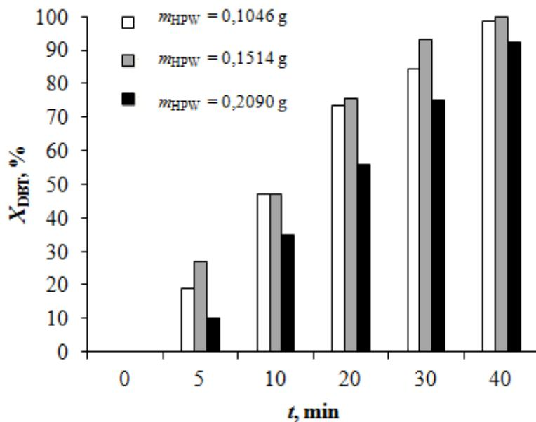
**Slika 4.35.** Utjecaj mase katalizatora,  $m$ , u sustavu vodikov peroksid/dodekafosfovolframova kiselina na konverziju DBT-a,  $X_{\text{DBT}}$ , u ovisnosti o vremenu reakcije,  $t$  ( $T = 50 \text{ }^{\circ}\text{C}$ ,  $P = 70 \text{ W}$ , 80 %)
