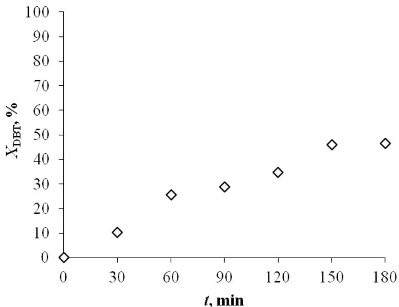
**Slika 4.49.** Ovisnost konverzije DBT-a,  $X_{\text{DBT}}$ , o vremenu reakcije,  $t$ , u sustavu vodikov peroksid/octena kiselina ( $T = 50^\circ\text{C}$ ,  $\text{O/K} = 1/2$ ,  $n = 500 \text{ o min}^{-1}$ )
