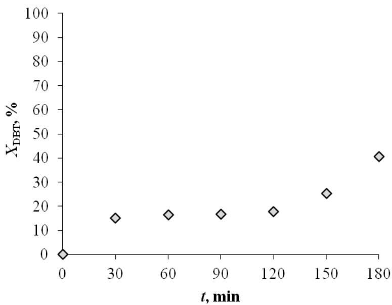
**Slika 4.50.** Ovisnost konverzije DBT-a,  $X_{\text{DBT}}$ , o vremenu reakcije,  $t$ , u sustavu vodikov peroksid/octena kiselina ( $T = 50 \text{ }^{\circ}\text{C}$ ,  $\text{O}/\text{K} = 1/2$ ,  $n = 1000 \text{ o min}^{-1}$ )
