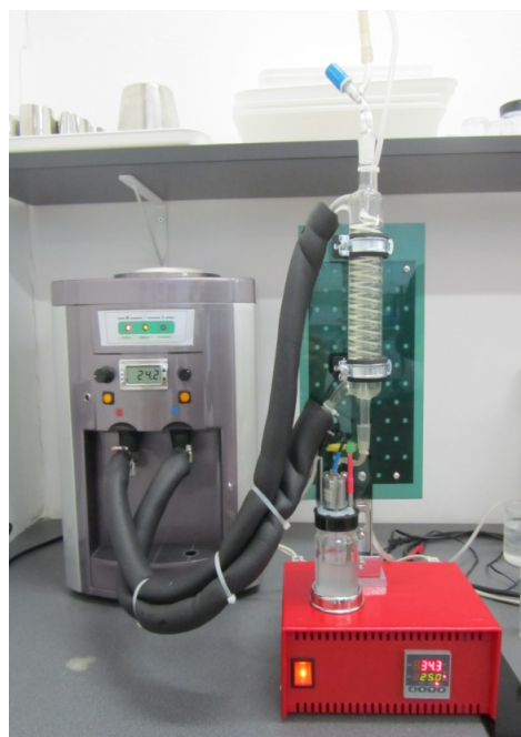
Slika 3.1. Fotografija i shematski prikaz aparature za ultrazvukom potpomognutu oksidacijsku desulfurizaciju
