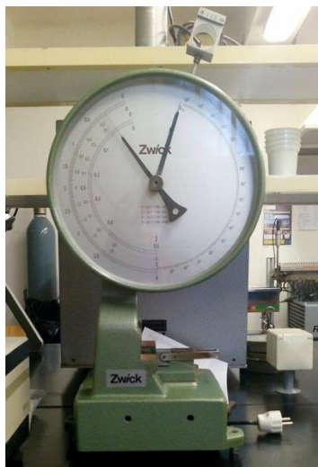
Slika 32: Uređaj za ispitivanje udarne žilavosti
