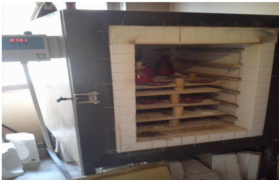
Slika 28 : Keramička peć BC-1200/260 u kojoj su pečene opeke
