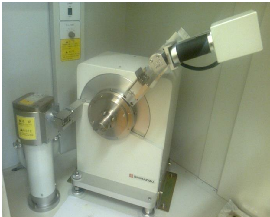
Slika 26 : Detalj rendgenske cijevi i okomitog goimetra
