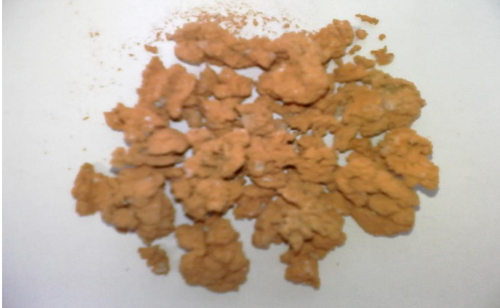
Slika 49: Prikaz dehidriranog mulja izloženog temperaturi od 900 °C
