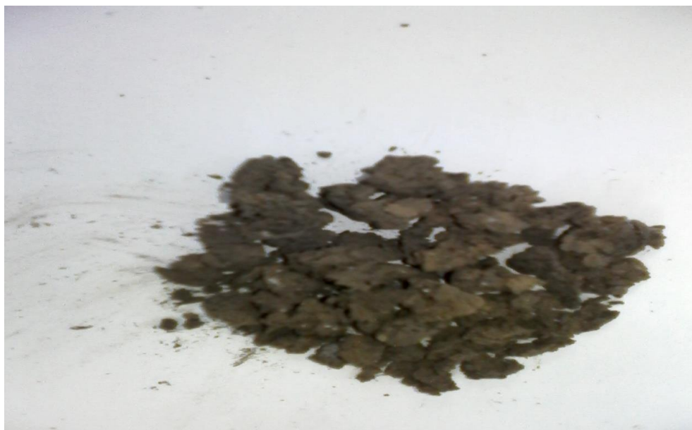
Slika 47: Prikaz dehidriranog mulja izloženog temperaturi od 500 °C
