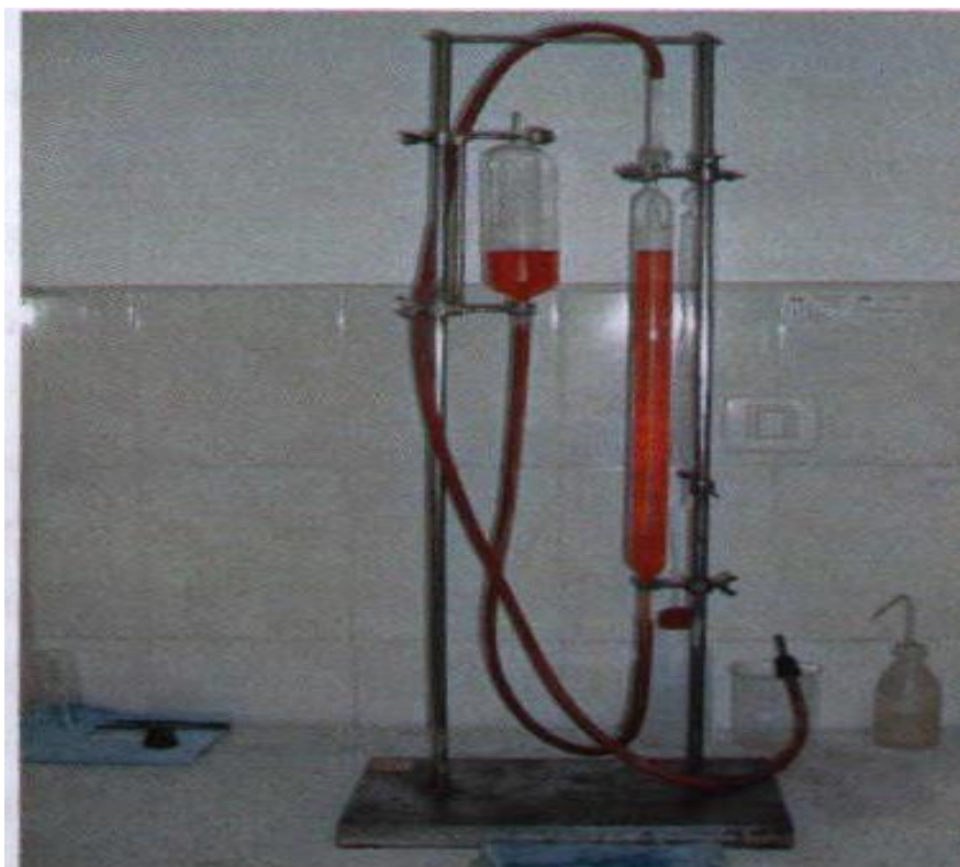
Slika 23 : Aparatura za određivanje CO 2 – kalcimetar
