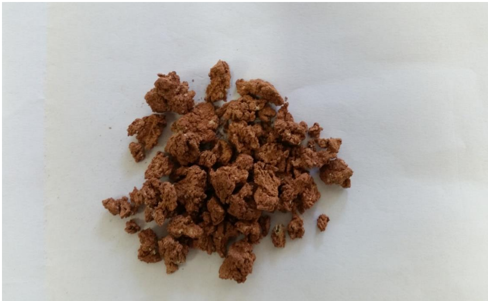
Slika 50: Prikaz dehidriranog mulja izloženog temperaturi od 1050°C
