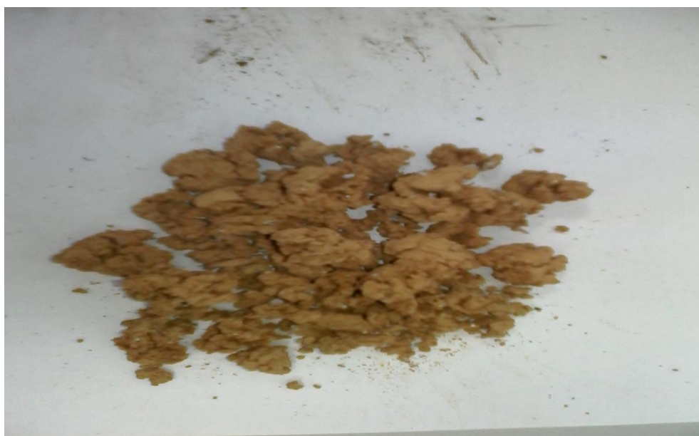
Slika 48: Prikaz dehidriranog mulja izloženog temperaturi od 700 °C
