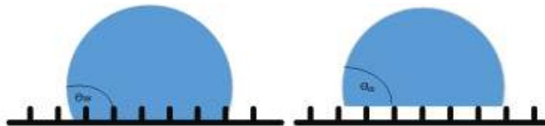
Slika 3.21. a) Wenzelov, b) Cassie – Baxterov kontaktni kut za neravnu, nehomogenu površinu 98
