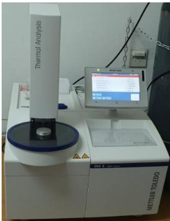
Slika 25. Prikaz DSC uređaja Mettler Toledo, marke DSC 3+
