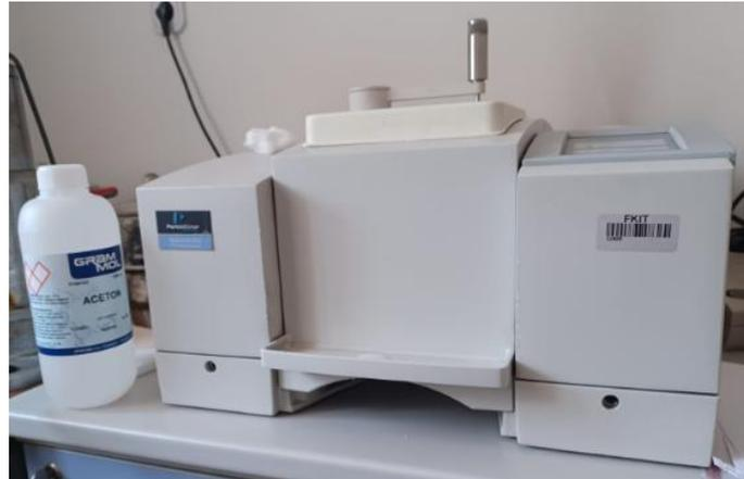
Slika 26. FTIR uređaj PerkinElmer Spectrum One
