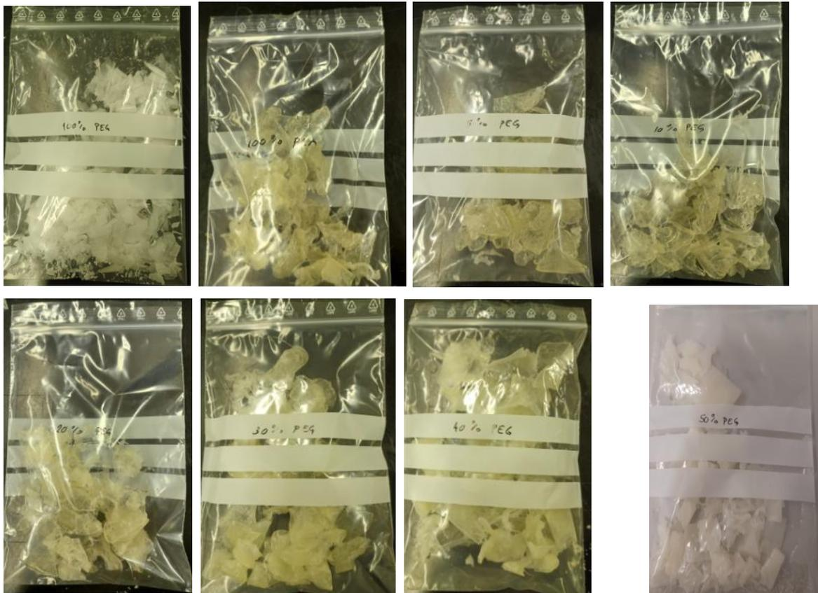
Slika 22. Uzorci nakon umješavanja u Brabender gnjetilici
