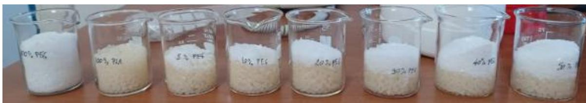
Slika 19. Pripremljene odvage polimera za umješavanje na Brabender gnjetilici (s lijeva na desno : 100 % PEG, 100% PLA, PLA/ 5% PEG, PLA/ 10% PEG, PLA/ 20% PEG, PLA/ 30% PEG, PLA/ 40% PEG, i PLA/ 50% PEG)
