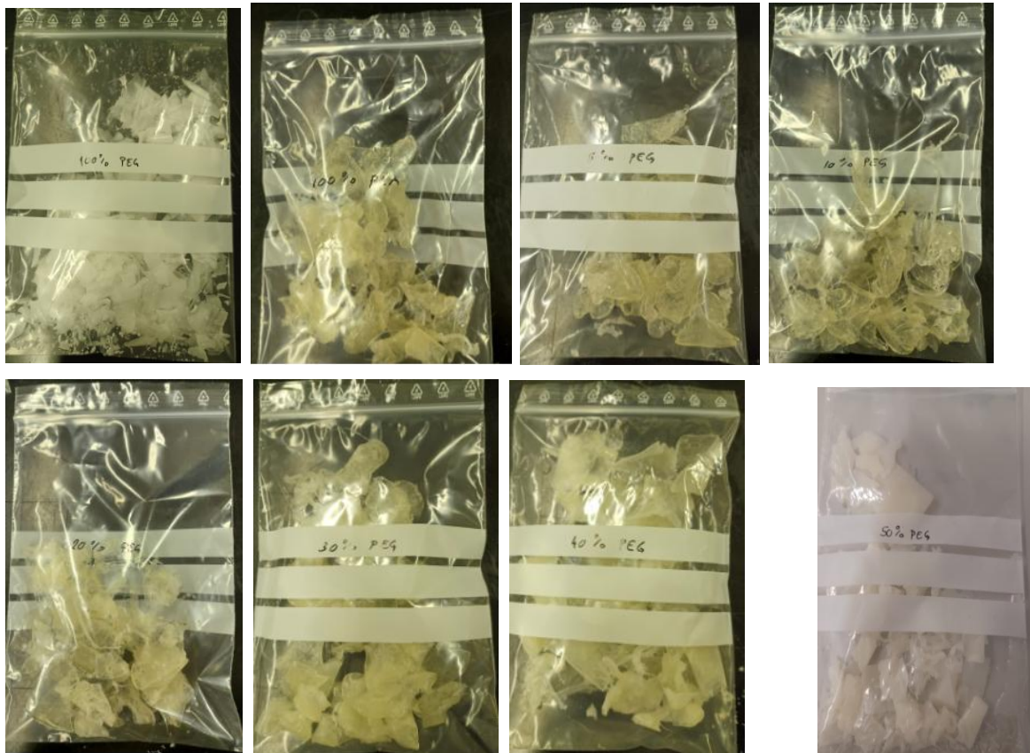
Slika 22. Uzorci nakon umješavanja u Brabender gnjetilici
