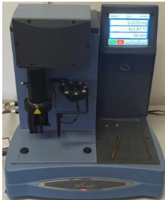
Slika 27. Uređaj za termogravimetrijsku analizu, TA Instruments Q500
