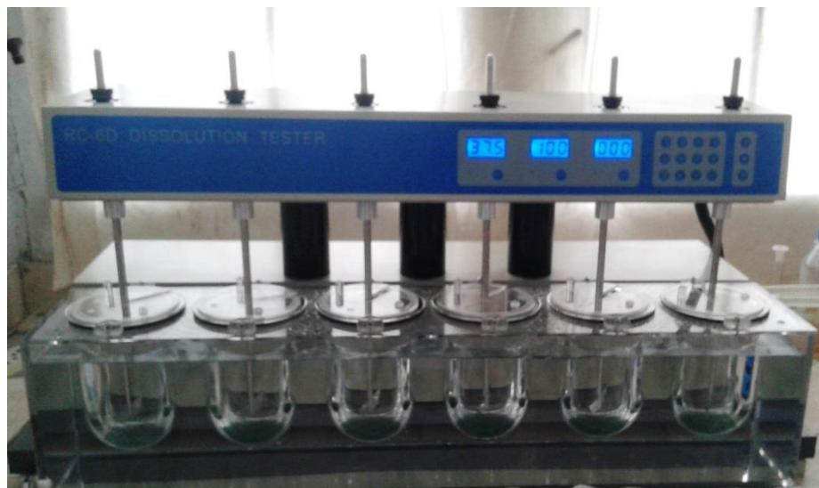
**Slika 16.** Uređaj za ispitivanje brzine otpuštanja djelatne tvari RC-6D, Zhengzhou Nanbei
