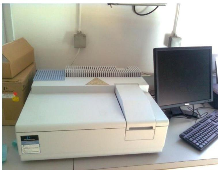
**Slika 13.** UV/VIS spekprofotometar Perkin elmer, Lambda 35
