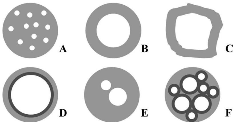
**Slika 1.** Morfologija različitih vrsta kapsula: A – matrica; B – jednostavna mikrokapsula; C – mikrokapsula nepravilnog oblika; D – višepregradna mikrokapsula; E – višejezgrena mikrokapsula; F – agregati mikrokapsule
