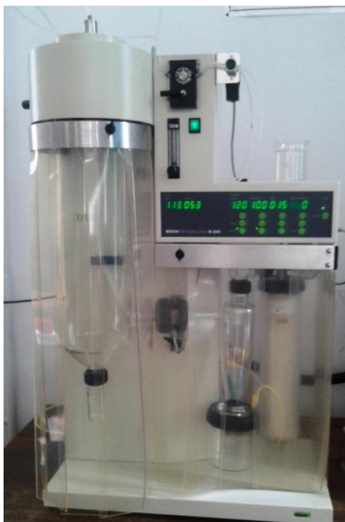
Slika 12. Sušionik s raspršivanjem B-290 ( Büchi Labortechnik AG, Switzerland )
