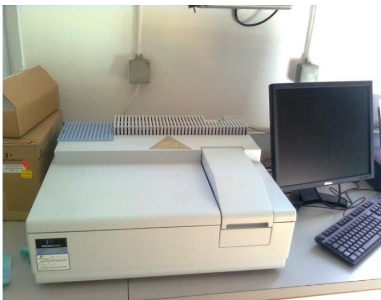
Slika 13. UV/VIS spektrofotometar Perkin elmer, Lambda 35
