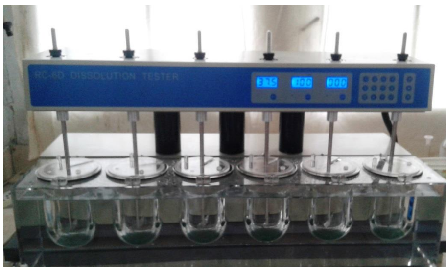
Slika 16. Uređaj za ispitivanje brzine otpuštanja djelatne tvari RC-6D, Zhengzhou Nanbei Instrument
