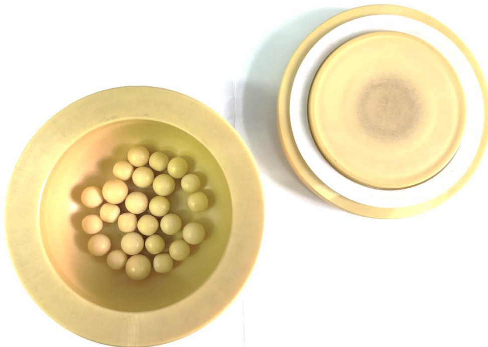
Slika 10. Posuda i kugle od cirkonijeva(II) oksida korištene za mehanokemijsku sintezu CeO_2
