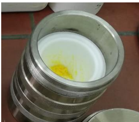
Slika 11. Hidrotermalni reaktor s umetkom i dobivenim produktom ( \text{CeO}_2 )
