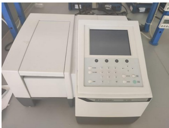
Slika 24. UV/Vis spektrometar Shimadzu UV-1280.
