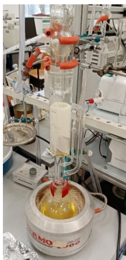
Slika 20. Soxhlet ekstrakcija bijelog papra i filtrirani ekstrakti, redom bijeli, crni, zeleni i voatsiperifery papra.
