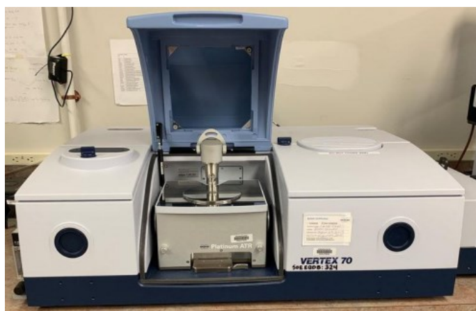
Slika 25. FTIR spektrometar Bruker Vertex 70.
