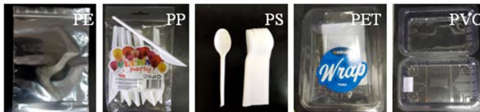
Slika 17. Prikaz plastičnih predmeta korištenih za dobivanje mikroplastike.
