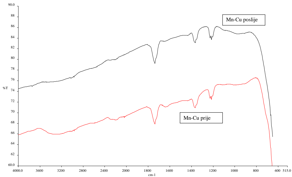
Slika 4.4. Rezultati FTIR analize uzorka katalizatora Mn-Cu prije i nakon provedenih eksperimenata
