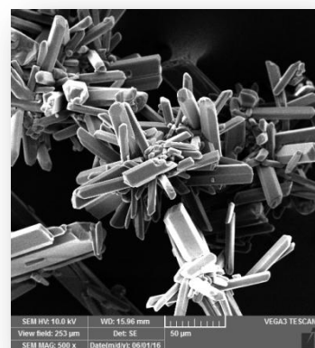
Uzorak s acetonitrilom i kloroformom, uvećanje 500x
