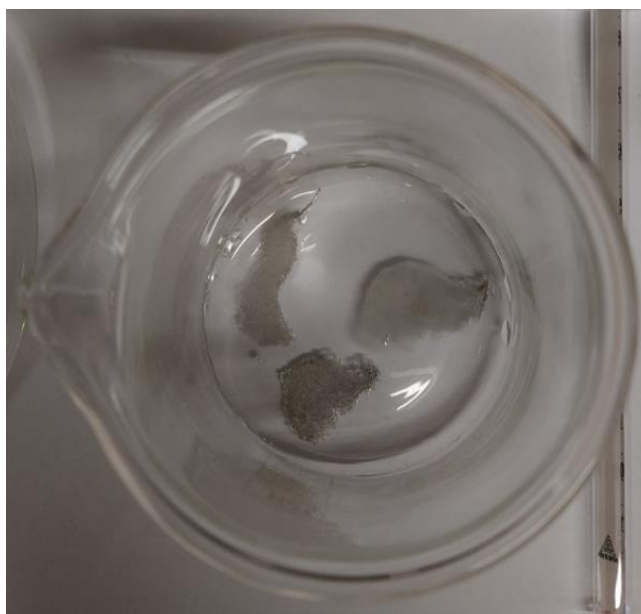
Slika 3.4. Mjehurići molekularnog \text{O}_2 , oslobođeni na Pt mrežicama
