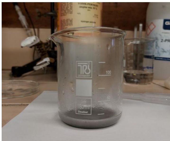
Slika 3.3. Egzotermna reakcija otapanja volframova praha u 30% otopini \text{H}_2\text{O}_2
