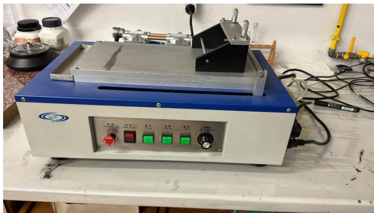
Slika 3.1. Uređaj za nanošenje tankih filmova – „ Doctor Blade “ (Gelon Lib, Kina)
