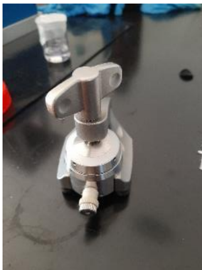
Slika 3.6. El-Cell ćelija za testiranje galvanskih ćlanaka u tro-elektroodnom sustavu s umetnutom referentnom elektrodom
