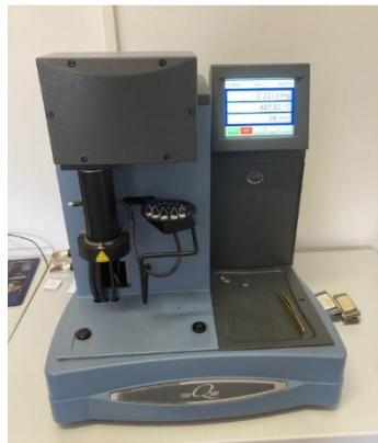
Slika 23. Termogravimetar TA Instruments Q500
