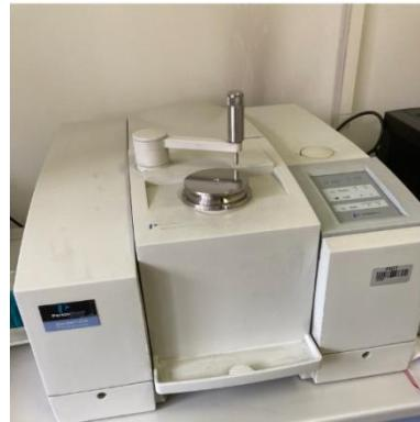
Slika 24. Uređaj FTIR Spectrum One
