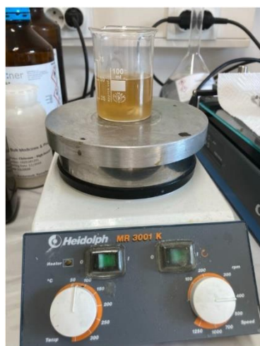
Slika 20. Priprava prevlake od hitozana na magnetskoj mješalici
