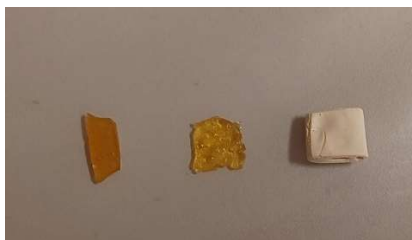
Slika 55. Uzorak prikazan kroz faze ispitivanja na početku, nakon vađenja iz otopine znoja, nakon sušenja
