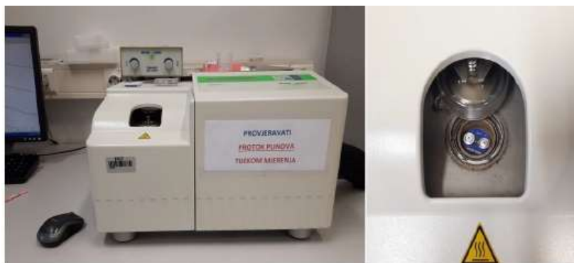
Slika 25. Diferencijalni pretražni kalorimetar, Mettler Toledo DSC 823e .
