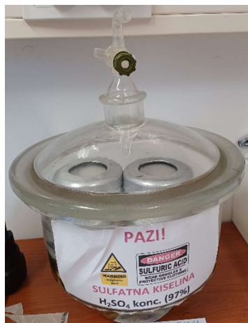
Slika 28. Herfeld-ov uređaj za određivanje propusnosti vodene pare.
