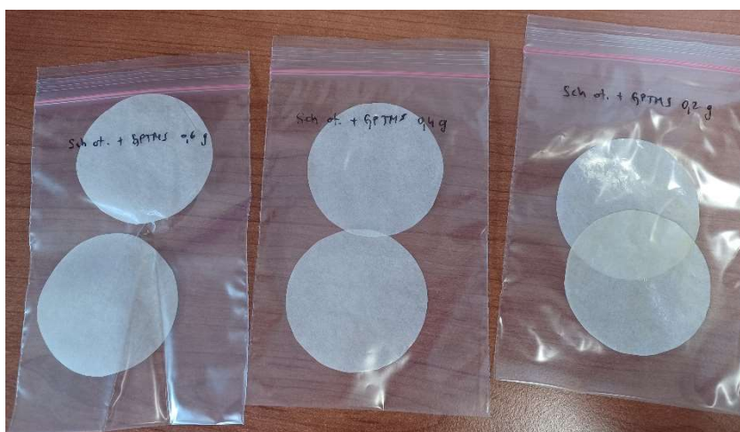
Slika 29. Epruvete za ispitivanja propusnosti vodene pare.
