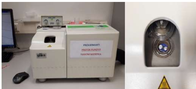
Slika 25. Diferencijalni pretražni kalorimetar, Mettler Toledo DSC 823e .
