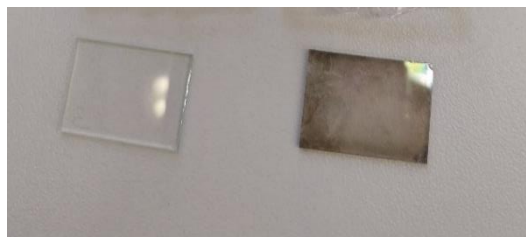
Slika 12. ITO stakalce sa ZnO nanoštapićima (lijevo) i ITO stakalce s \text{TiO}_2 nanostrukturama, nakon kalcinacije (desno)
