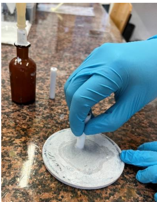
Slika 3.1. Poliranje GC elektrode s \text{Al}_2\text{O}_3 lampom
