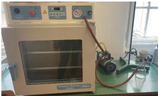
Slika 3.7. Aparatura za pripremu GO papira
