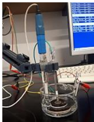
Slika 3.8.rGO papir dobiven nakon elektrokemijske redukcije Slika 3.9.Aparatura za redukciju GO papira
