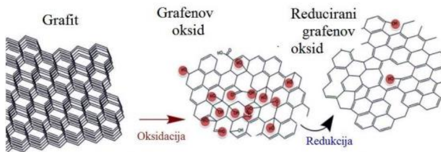
Slika 2.5. Struktura grafita, GO i rGO
