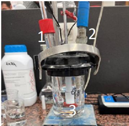
Slika 3.4. Troelektroadni sustav: 1-protuelektroda 2-referentna, 3-radna
