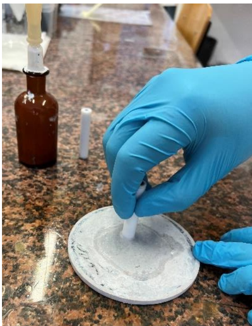
Slika 3.1. Poliranje GC elektrode s \text{Al}_2\text{O}_3 lampom
