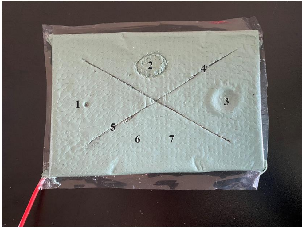
Slika 17. Prikaz pozicija impedancijskog mjerenja na mehanički oštećenom uzorku
