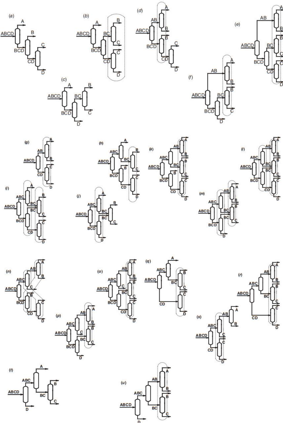
Slika 2.6. Sekvence destilacijskih kolona za dobivanje četiri proizvoda [12]
