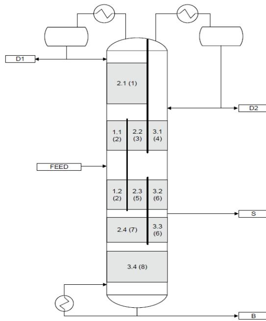
Slika 2.80. Shematski prikaz KRS 2-3-3 konfiguracije [19]
