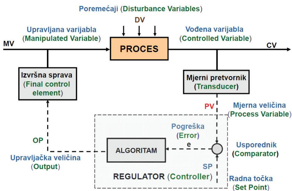
Slika 2.11. Shematski prikaz regulacijskog kruga [22]
