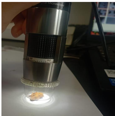
Slika 24. Prikaz upotrebe digitalnog mikroskopa na korozivskim produktima.
