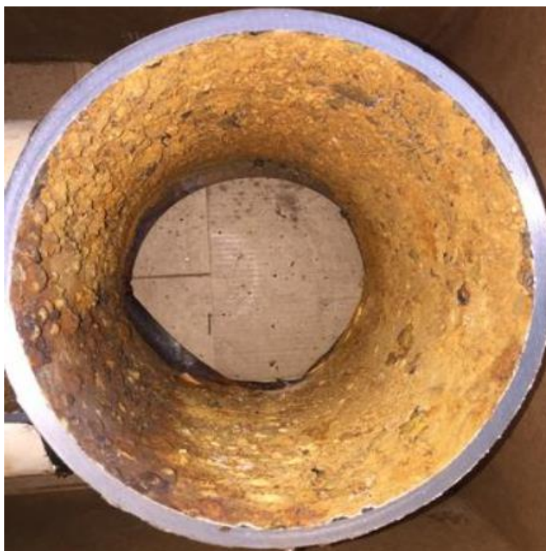
Slika 7. Zahrđala unutrašnjost vodovodne cijevi koja sadrži krom koji reagira s ostacima dezinfekcijskih sredstava za vodu i stvara kancerogeni šesterovalentni krom.
