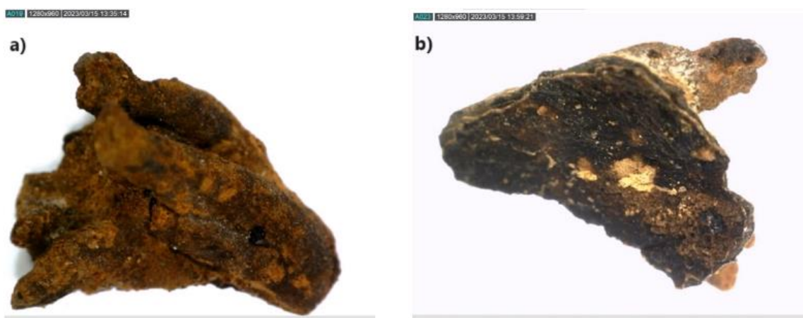
Slika 30. Mikroskopski prikaz uzorka 1.2. a) s gornje strane izložene vodi i b) s donje strane uz površinu cijevi pod povećanjem od 50×.32
