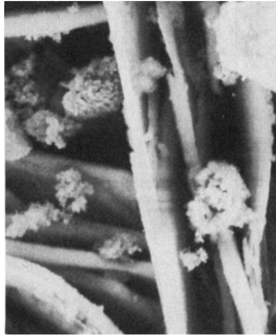
Slika 51. Unutrašnjost tuberkula prikazuje velike lamelarne kristale [30].
