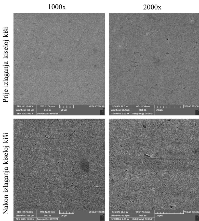
Slika 4.8. SEM slike uzorka zaštićenog filmom COOH-PA (prskanje 5x, 5min, S sobna) prije i nakon 3 tjedna izlaganja umjetnoj kiseloj kiši.
