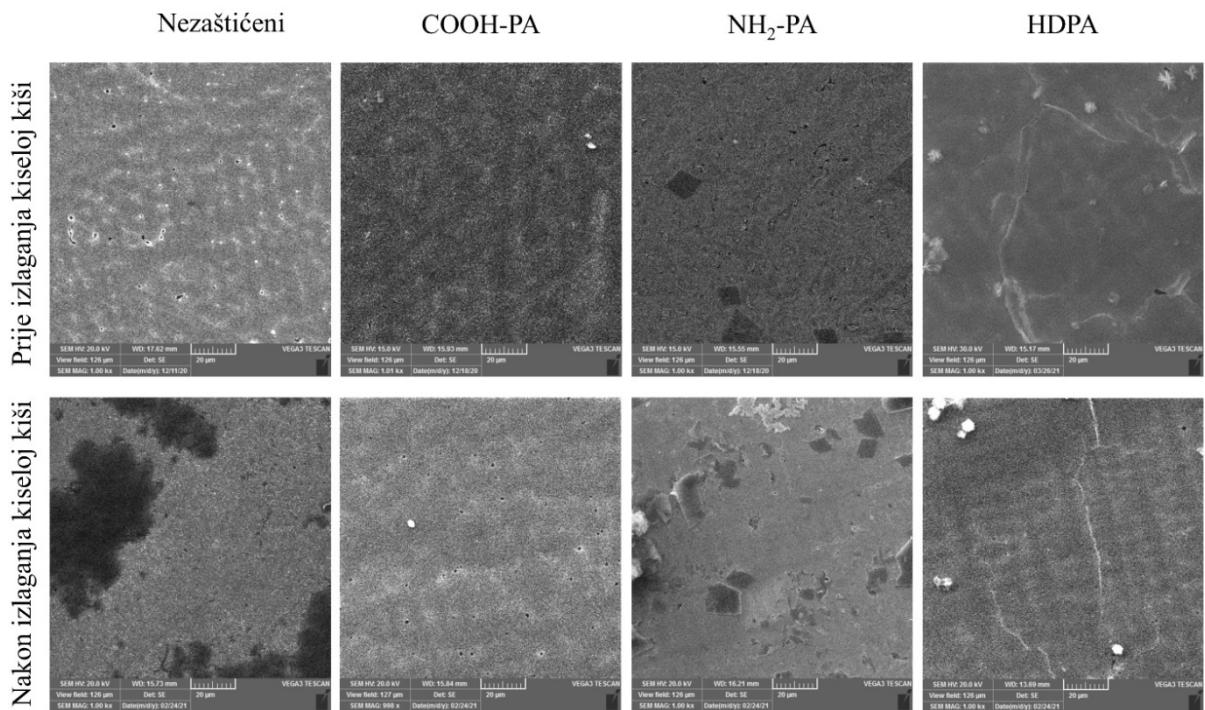
Slika 4.26. SEM slike nezaštićenog uzorka i uzoraka zaštićenih filmovima fosfonskih kiselina formiranih iz 1 mM otopina prije i nakon izlaganja umjetnoj kiseloj kiši pri povećanju od 1000x.<sup>81</sup>
