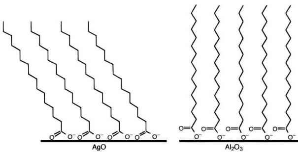
Slika 2.7. Shematski prikaz vezanja masnih kiselina na Ago i  $\text{Al}_2\text{O}_3$ .<sup>76</sup>
