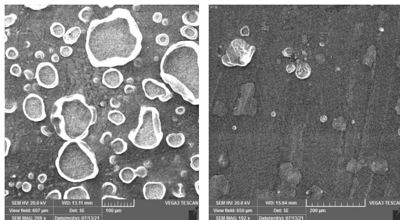
Slika 4.58. SEM slike patine zaštićene a) Paraloidom B72 i b) patine na koju je kistom nanesena COOH-PA i potom zaštićena Paraloidom B72, nakon tri tjedna izlaganja umjetnoj kiseloj kiši.<sup>82</sup>
