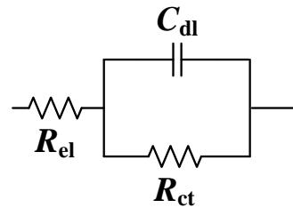
Slika 3.13. Jednostavni ekvivalentni električni krug.
