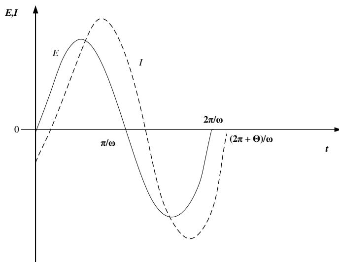
Slika 3.9. Sinusoidalni val za narinuti potencijal ( $E$ ) i rezultirajuću struju ( $I$ ).<sup>2</sup>
