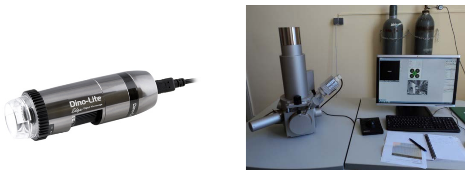
Slika 3.24. Optički mikroskop (lijevo) i pretražni elektronski mikroskop (desno).
