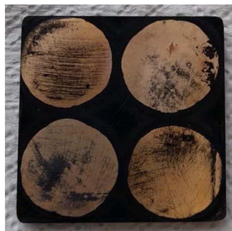
Slika 4.60. Ispitivanje prionjivosti premaza na patiniranoj površini bronce.
