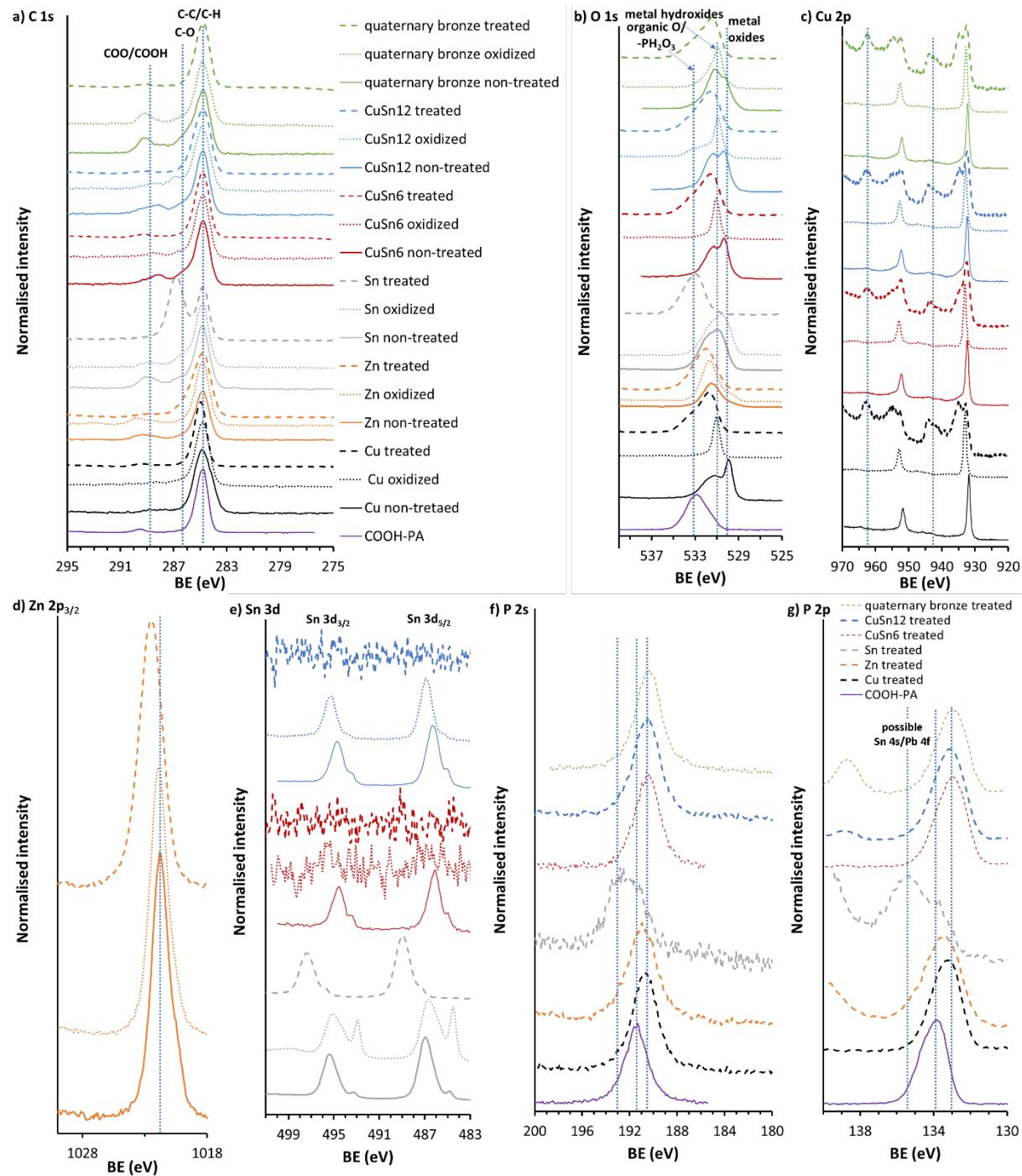
Slika 4.28. XPS spektar visoke rezolucije a) C 1s, b) O 1s, c) Cu 2p, d) Zn 2p<sub>3/2</sub>, e) Sn 3d, f) P 2s, and g) P 2p za neoksidirani uzorak, nezaštićeni i zaštićeni.<sup>187</sup>
