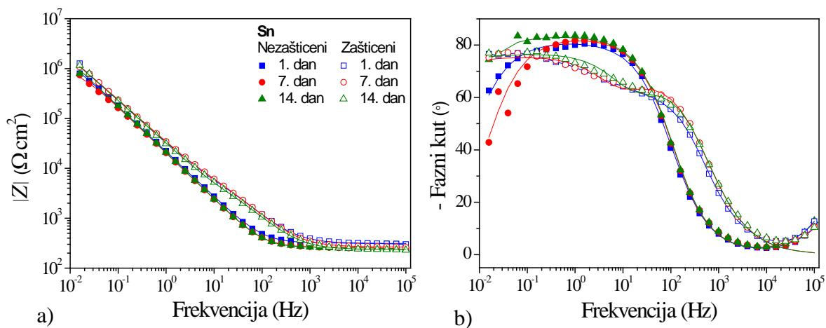
Slika 4.32. EIS – Bodeov prikaz za nezaštićeni i zaštićeni uzorak kositara prvi dan, nakon tjedan dana i nakon dva tjedna izlaganja umjetnoj kiseloj kiši: a) modul impedancije i b) fazni kut (simboli – eksperimentalni podaci, linije – rezultati dobiveni korištenjem modela prikazanih na slici 4.33.).<sup>187</sup>
