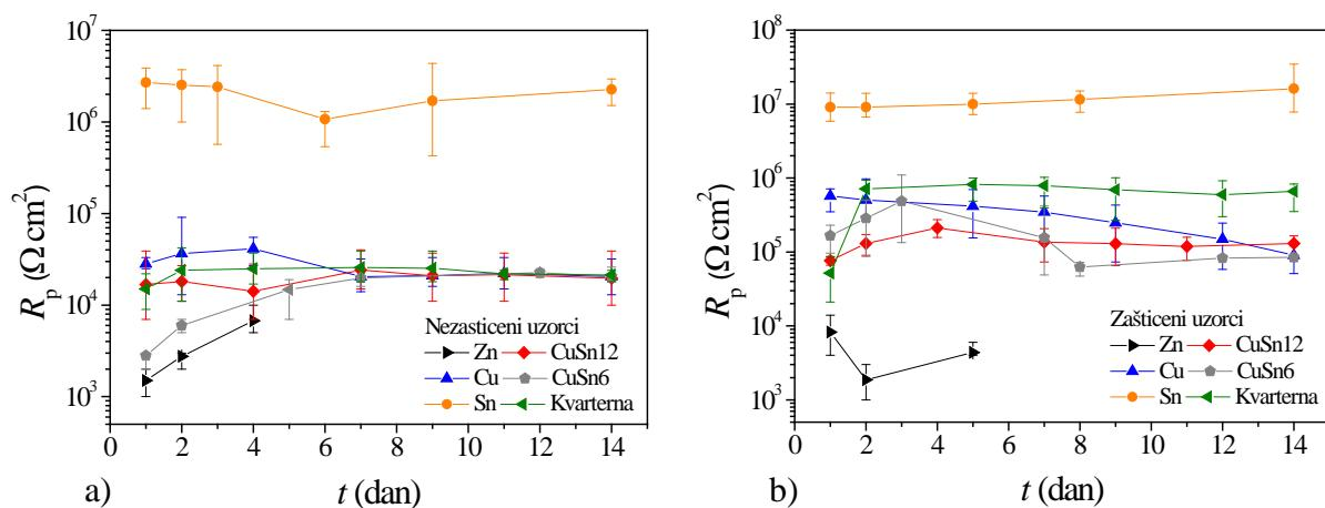
Slika 4.29. Ovisnost polarizacijskog otpora o vremenu u umjetnoj kiseloj kiši za nezaštićene uzorke i uzorke zaštićene filmovima COOH-PA.<sup>187</sup>
