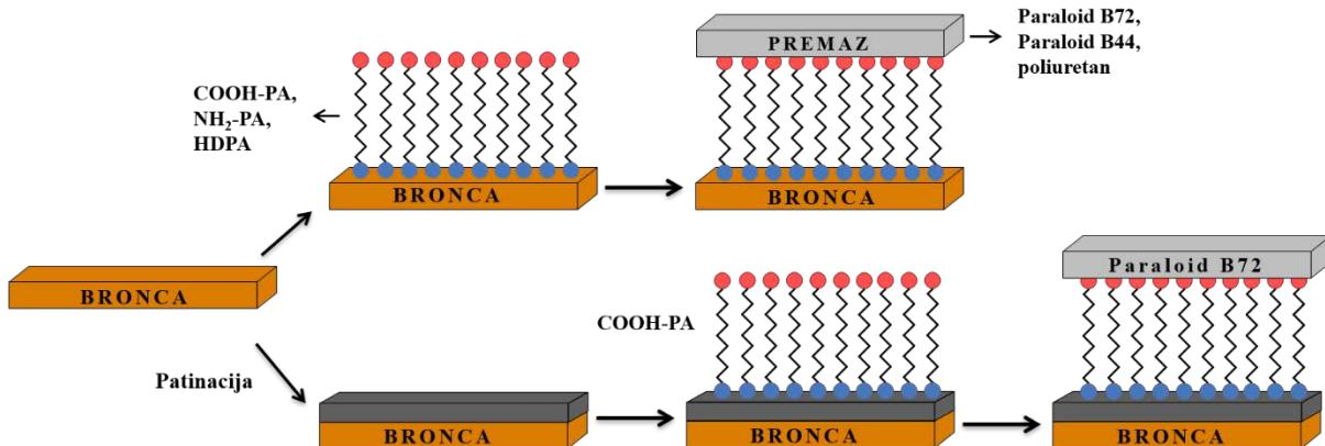
Slika 3.1. Postupak pripreme uzorka.
