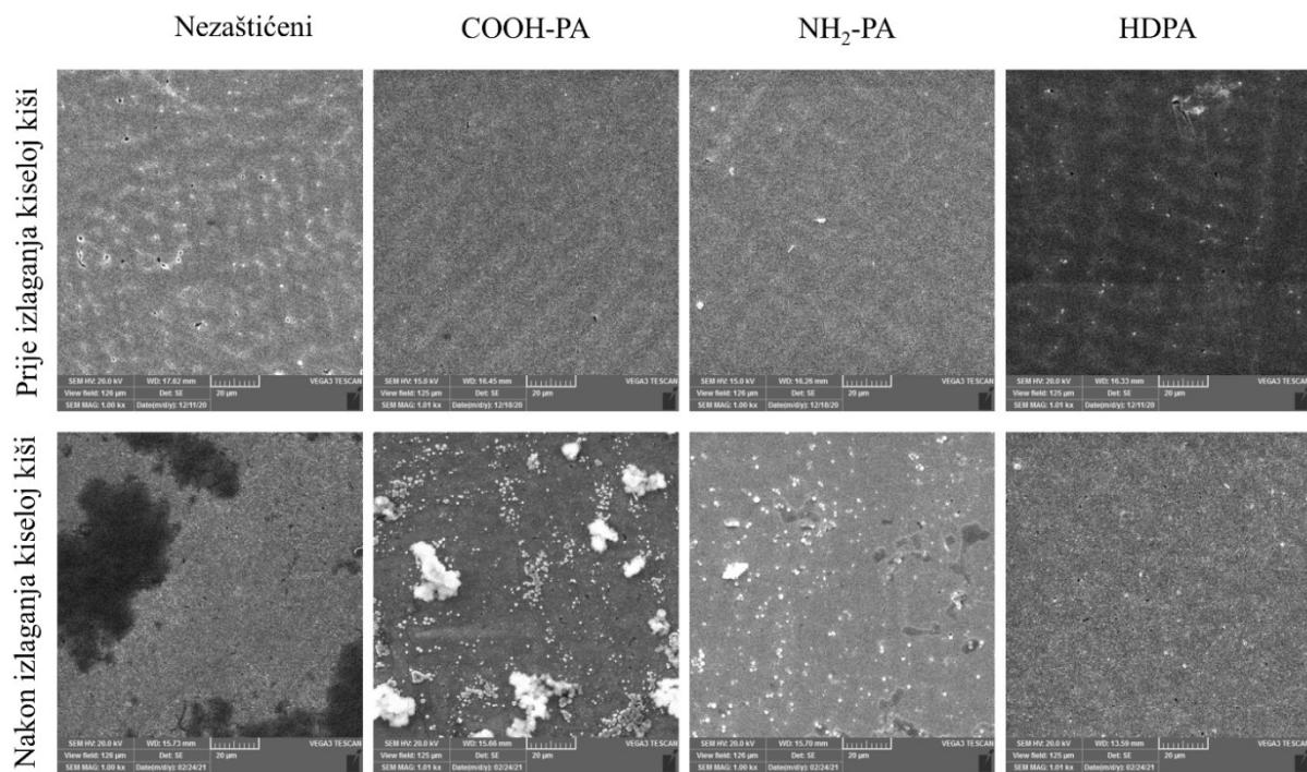
Slika 4.25. SEM slike nezaštićenog uzorka CuSn12 bronce i uzoraka zaštićenih filmovima fosfonskih kiselina formiranih iz 0,1 mM otopina prije i nakon izlaganja umjetnoj kiseloj kiši pri povećanju od 1000x.<sup>81</sup>
