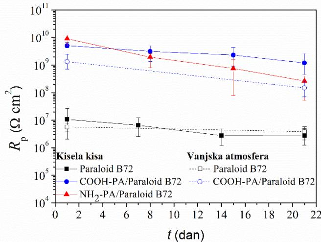
Slika 4.41. Ovisnost polarizacijskog otpora o vremenu u umjetnoj kiseloj kiši i vanjskoj atmosferi za uzorke zaštićene Paraloidom B72 sa i bez predtretmana s COOH-PA i NH<sub>2</sub>-PA.
