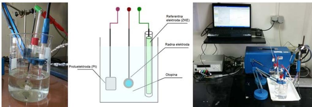
Slika 3.6. Izgled i shematski prikaz troelektrodne čelije te aparature korištene pri elektrokemijskim mjerjenjima.<sup>69</sup>
