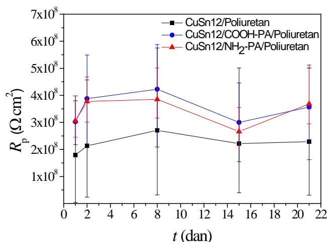
Slika 4.48. Ovisnost polarizacijskog otpora o vremenu u umjetnoj kiseloj kiši za uzorke CuSn12 bronce zaštićene poliuretanskim premazom sa i bez predtretmana s COOH-PA i NH<sub>2</sub>-PA.
