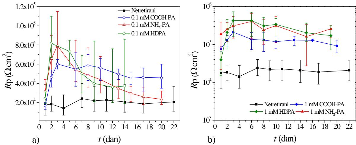
Slika 4.17. Ovisnost polarizacijskog otpora o vremenu u umjetnoj kiseloj kiši za nezaštićeni uzorak CuSn12 bronce i uzorke zaštićene filmovima COOH-PA, NH<sub>2</sub>-PA i HDPA različitih koncentracija.<sup>81</sup>
