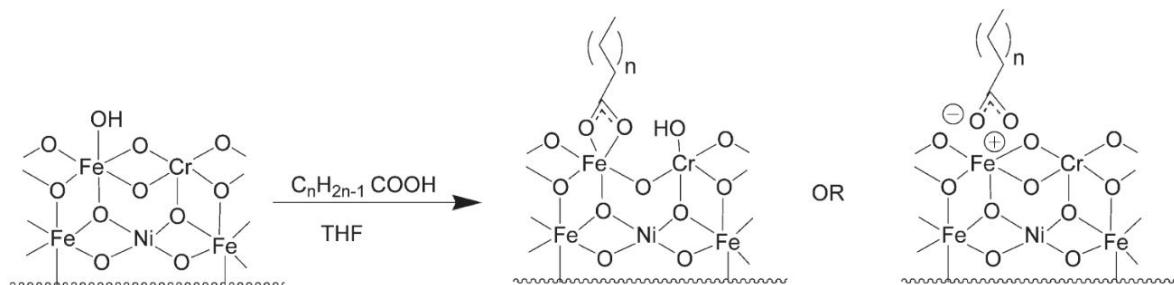
Slika 2.8. Predložene sheme vezanja organske kiseline na površinama metalnih oksida korištenjem karboksilne kiseline na čeliku SS316L: (lijevo) kovalentno i (desno) ionsko vezanje.<sup>54</sup>
