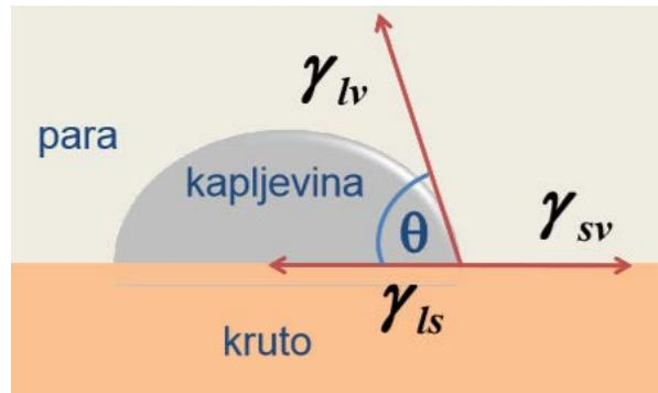
Slika 3.16. Određivanje kontaktnog kuta  $\theta$ .<sup>138</sup>
