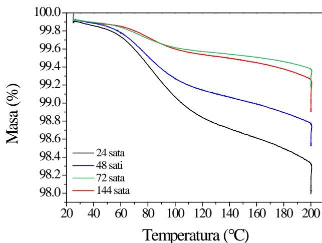
Slika 4.40. Termogravimetrijske krivulje Paraloida B72 sušenog 24, 48, 72 i 144 sata na sobnoj temperaturi.
