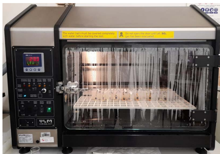
Slika 3.26. Komora za ubrzana korozivna ispitivanja.
