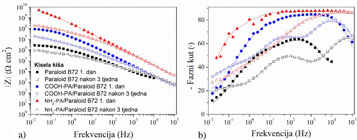
Slika 4.42. EIS – Bodeov prikaz za uzorak CuSn12 bronce zaštićen Paraloidom B72 sa i bez predtretmana s COOH-PA ili NH<sub>2</sub>-PA, prvi dan i nakon tri tjedna izlaganja umjetnoj kiseloj kiši: a) modul impedancije i b) fazni kut (simboli – eksperimentalni podaci, linije – rezultati dobiveni korištenjem modela prikazanih na slici 4.43.).
