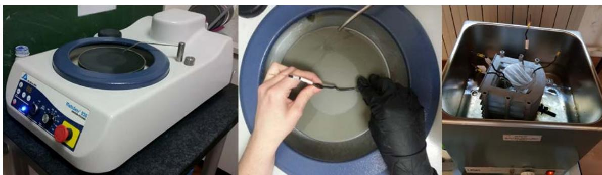
Slika 3.3. Mehaničko strojno poliranje uzorka i odmašćivanje u ultrazvučnoj kupelji.<sup>69</sup>
