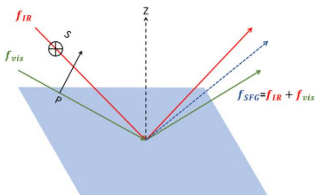
Slika 3.23. Shematski prikaz superponiranja vidljivog i IR zračenja.<sup>146</sup>
