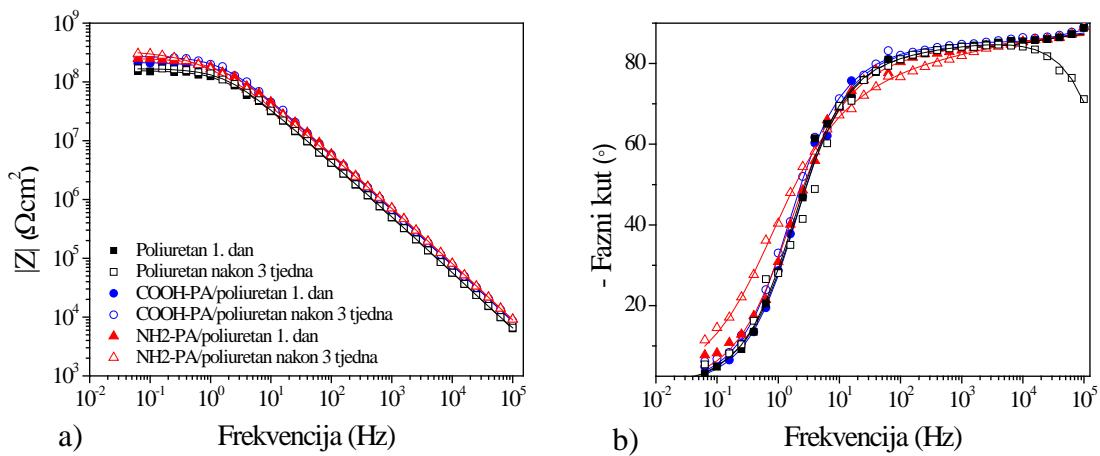
Slika 4.49. EIS – Bodeov prikaz za uzorak zaštićen poliuretanom sa i bez COOH-PA ili NH<sub>2</sub>-PA kao predtretmana prvi dan i nakon tri tjedna izlaganja umjetnoj kiseloj kiši: a) modul impedancije i b) fazni kut (simboli – eksperimentalni podaci, linije – rezultati dobiveni korištenjem modela prikazanih na slici 4.43.).
