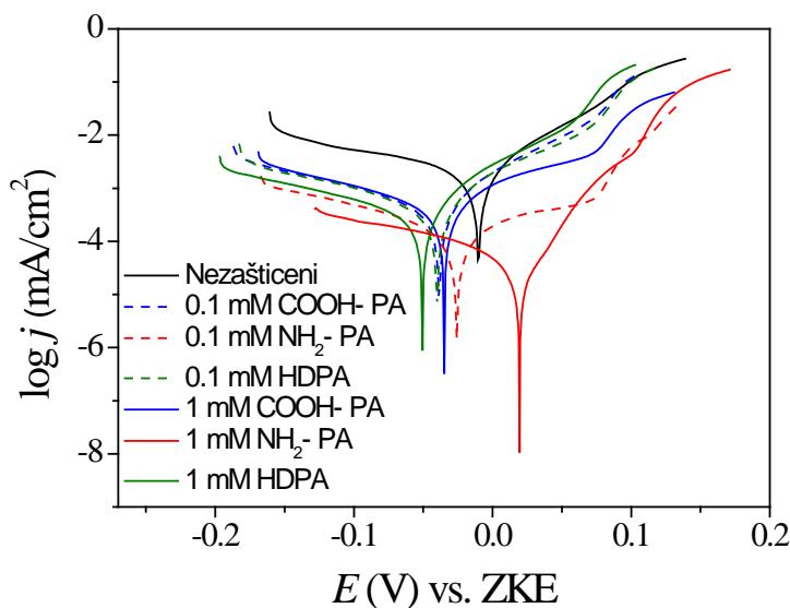
Slika 4.16. Polarizacijske krivulje dobivene u umjetnoj kiseloj kiši za nezaštićeni uzorak CuSn 12 bronce i uzorke zaštićene filmovima COOH-PA, NH<sub>2</sub>-PA i HDPA.<sup>81</sup>
