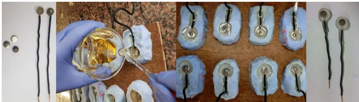
Slika 3.2. Postupak izrade radnih elektroda.<sup>69</sup>
