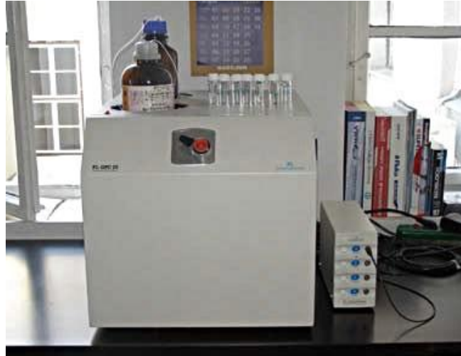
Slika 5. Uređaj za kromatografiju na propusnom gelu (GPC) Polymer Laboratories GPC 20
