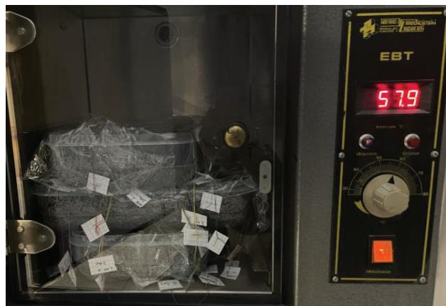
Slika 3.14. Posude s tlom i uzorcima papira tijekom provedbe pokusa biorazgradnje u termostatu pri 58 °C.
