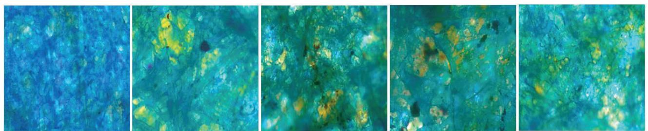
Slika 4.2. Mikrofotografije digitalnom cijan bojom otisnutog uzorka papira s 10% pulpe slame pšenice (1NP) u 0., 7., 14., 21. te 28. danu pokusa biorazgradnje snimljene optičkim mikroskopom pri povećanju  $P = 400x$ .
