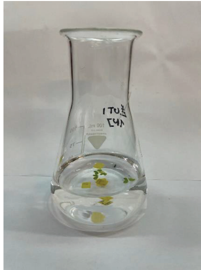
Slika 3.15. Prikaz testne tikvice za provedbu testa ekotoksičnosti koja je sadržavala mineralni medij, uzorak papira i vodenu leću Lemna minor .
