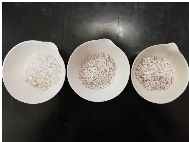
Slika 11. Dobiveni katalizatori na bazi perlita
