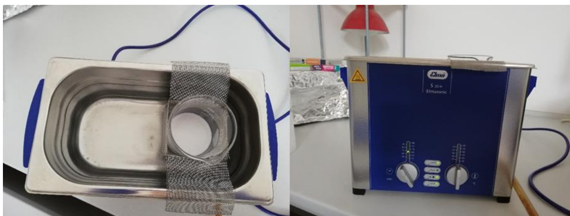
Slika 10. Prikaz sonikacije uzorka i uređaja za sonikaciju (Elmasonic S)
