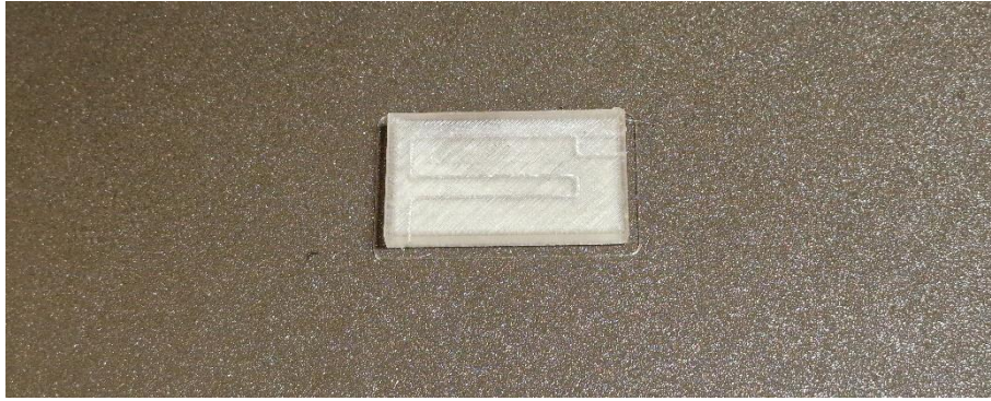
Slika 4.5.1.1 Mikroreaktor 3D-ispisan FFF tehnologijom
