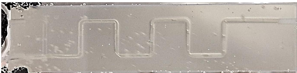
Slika 4.6.6.3. Profil strujanja u mikroreaktoru C10K pri \tau = 9,6 min
