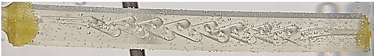
Slika 4.6.2.5. Profil strujanja u mikroreaktoru Tmod1 pri \tau = 8 min
