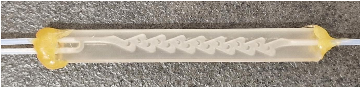
Slika 4.6.2.1. Način spajanja TMod1 mikroreaktora u sustav
