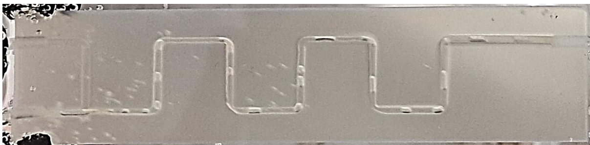
Slika 4.6.6.2. Profil strujanja u mikroreaktoru C10K pri \tau = 4,8 min
