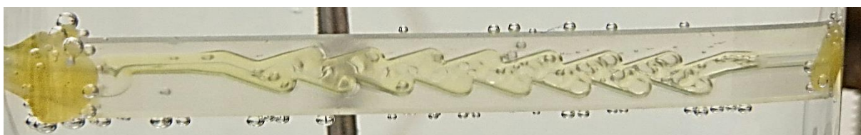
Slika 4.6.2.4. Profil strujanja u mikroreaktoru Tmod1 pri \tau = 4 min
