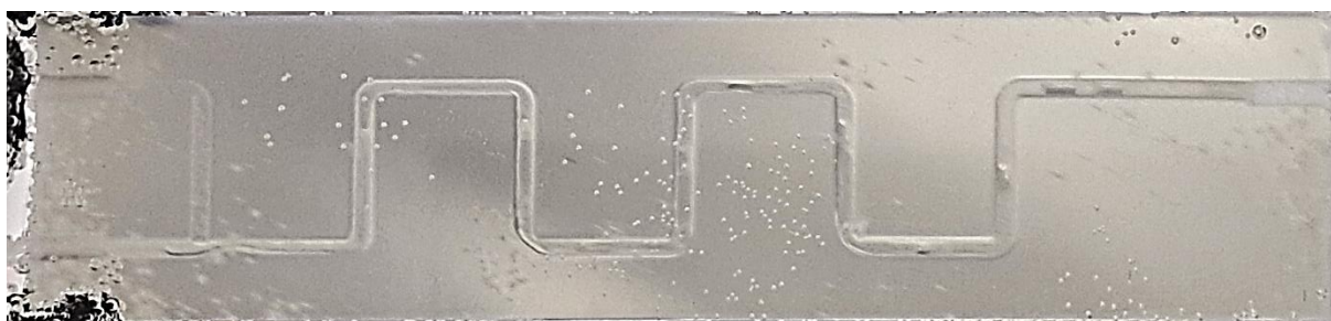
Slika 4.6.6.1. Profil strujanja u mikroreaktoru C10K pri \tau = 2,4 min
