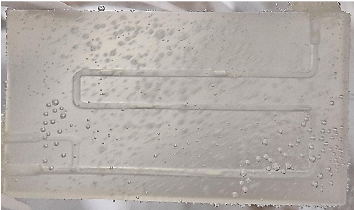
Slika 4.6.4.1. Profil strujanja u mikroreaktoru C5K pri \tau = 2,6 min
