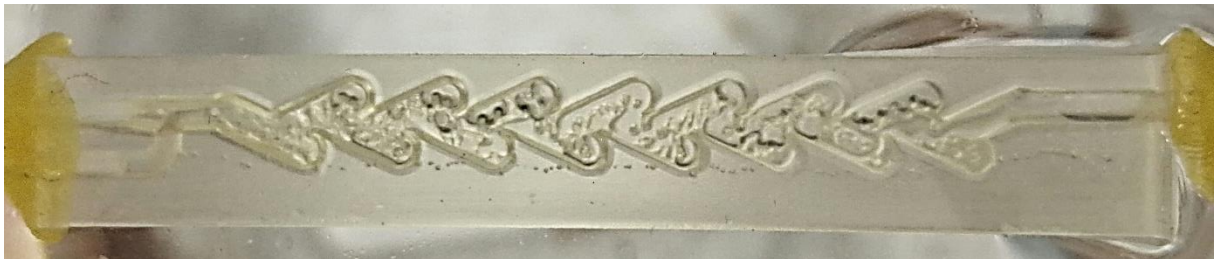
Slika 4.6.3.1. Profil strujanja u mikroreaktoru Tmod2 pri \tau = 1 min
