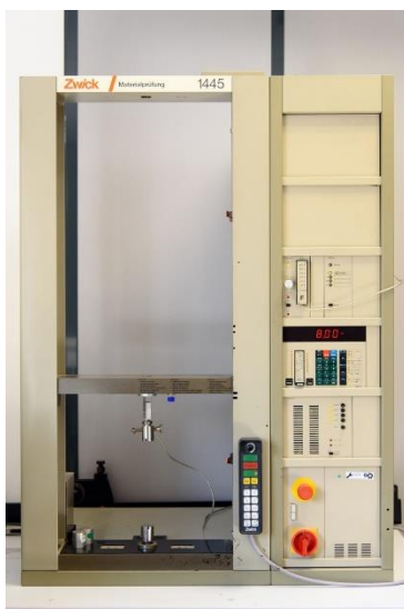
Slika 3.5. Mehanička kidalica Zwick UTM 1445
