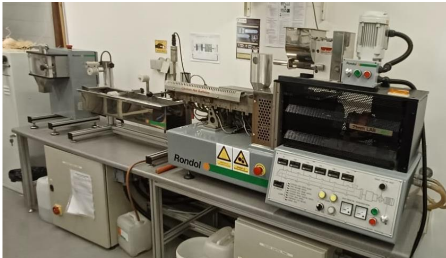
Slika 3.1. Dvopužni laboratorijski ekstruder, Randol Bench Top 21
