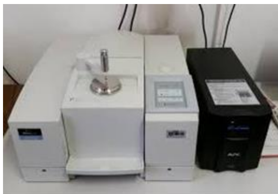
Slika 3.2. FTIR spektrofotometar PerkinElmer Spectrum One
