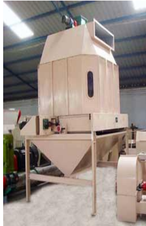
Slika 7. Struktura sustava hlađenja peleta. 9
