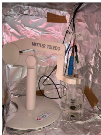
Slika 23. Nosači i troelektrodni sustav za elektrokemijska mjerenja
