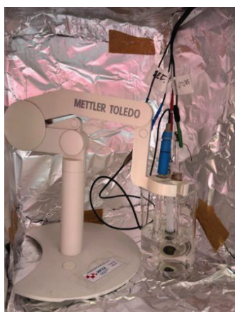
Slika 23. Nosači i troelektrodni sustav za elektrokemijska mjerenja
