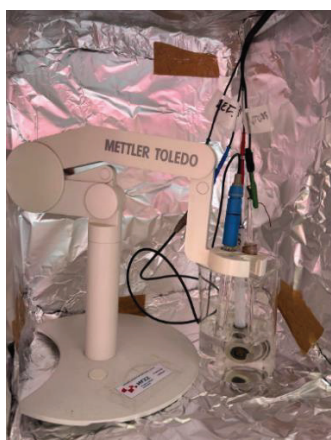
Slika 23. Nosači i troelektrodni sustav za elektrokemijska mjerenja
