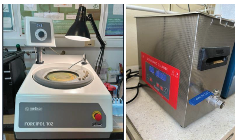
Slika 17. Mehaničko strojno poliranje uzoraka i odmašćivanje u ultrazvučnoj kupelji
