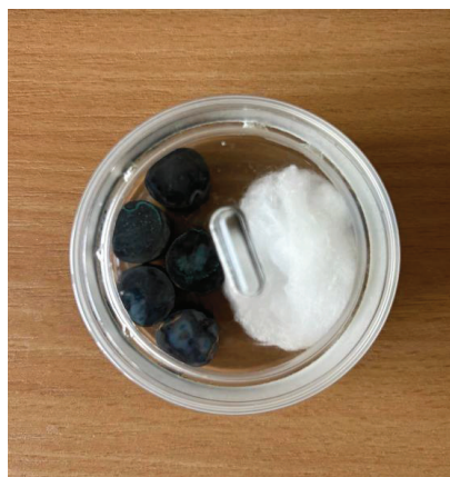
Slika 20. Razvijanje zelene patine
