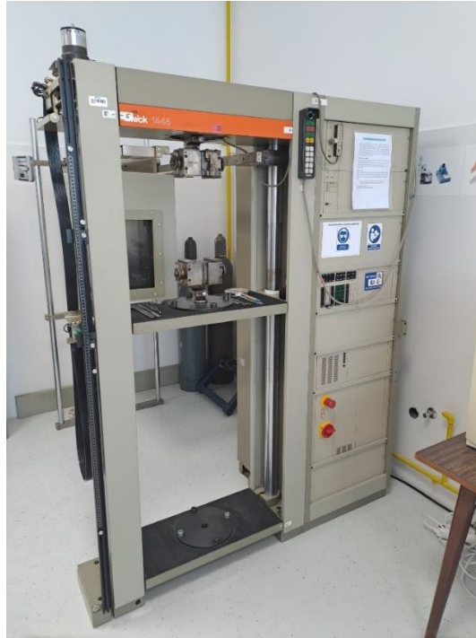
Slika 25. Mehanička kidalica Zwick 1445
