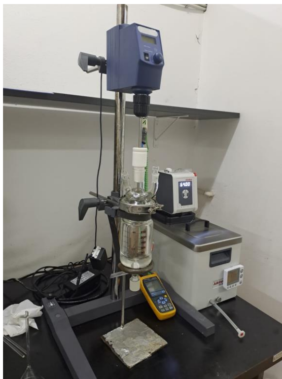
Slika 17. Aparatura za plastifikaciju škroba
