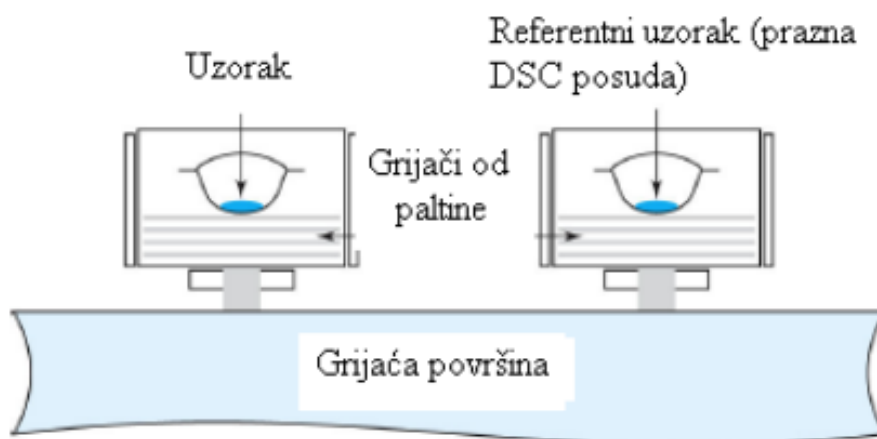
Slika 9. DSC s mogućnošću kompenzacije snage [18]
