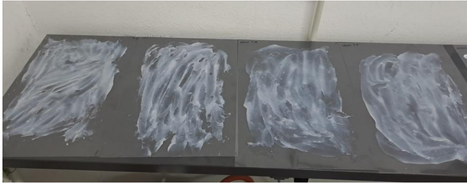
Slika 18. Sušenje filmova plastificiranog škroba
