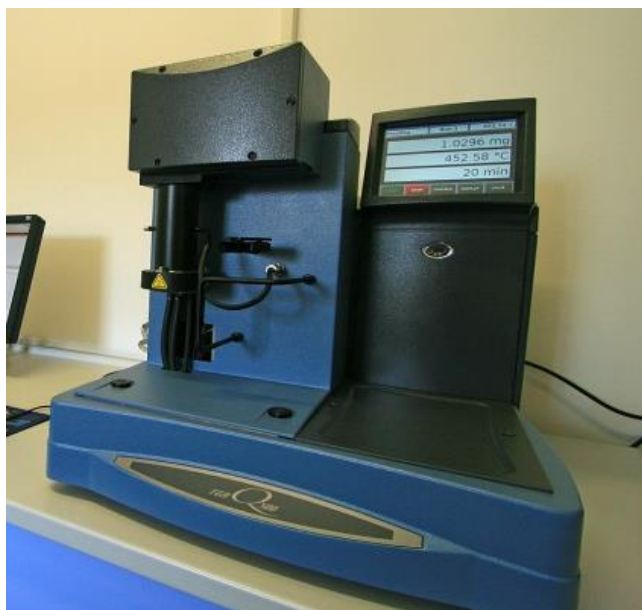
Slika 24. Termogravimetar Q500, TA Instruments
