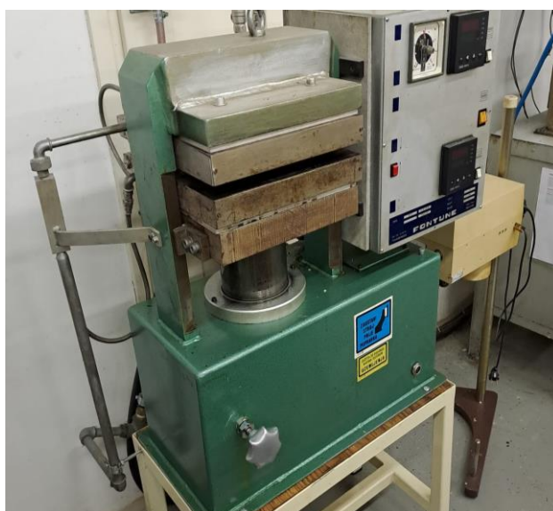
Slika 21. Preša za vruće prešanje Fontune
