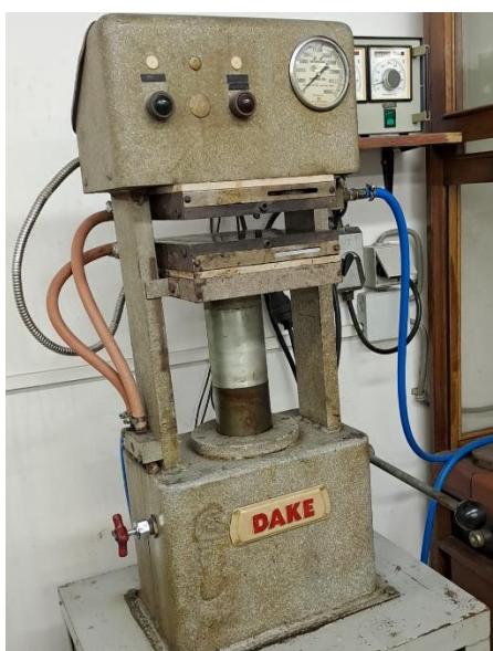
Slika 22. Hidraulička preša Dake Model 44-226
