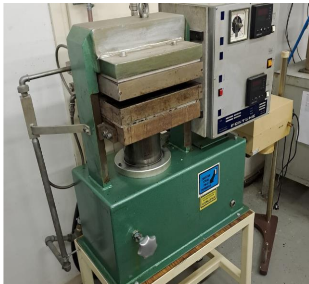
Slika 21. Preša za vruće prešanje Fontune
