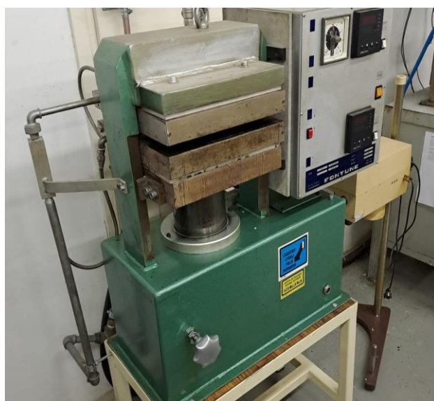
Slika 21. Preša za vruće prešanje Fontune
